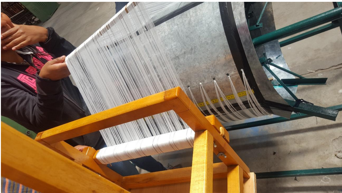
Fig. 49 Paso de urdición al telar vertical Elaborado por: Tamia C. Lima Lema
