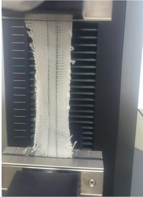
Fig. 65 Prueba N°2 Resistencia a la tracción Elaborado por: Tamia C. Lima Lema
