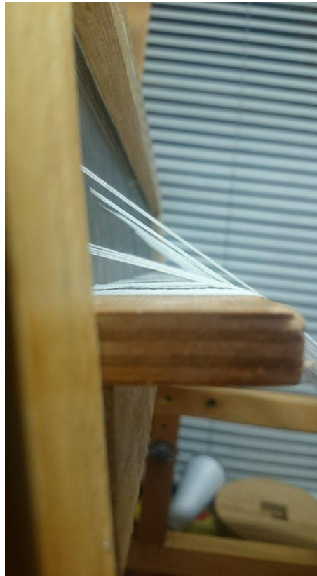
Fig. 55 Formación de la calada Elaborado por: Tamia C. Lima Lema
