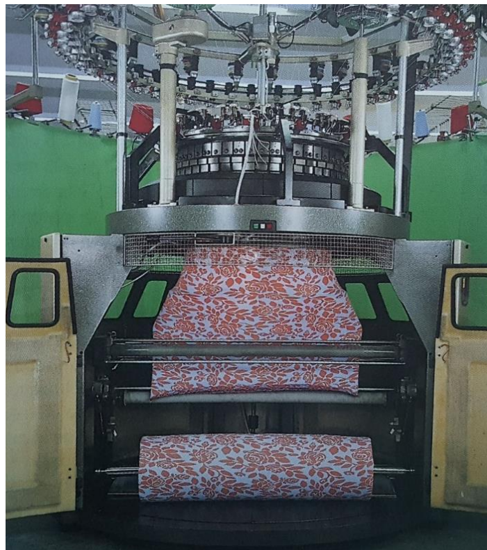
Fig. 21 Máquina circular de gran diámetro Fuente: (Iyer, 1997, p:49)
