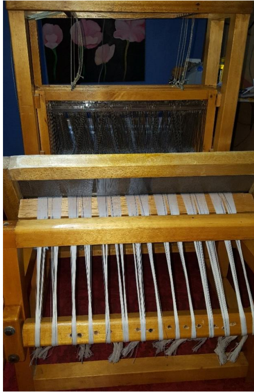
Fig. 54 Urdimbre/disposición en plegador de tela Elaborado por: Tamia C. Lima Lema
