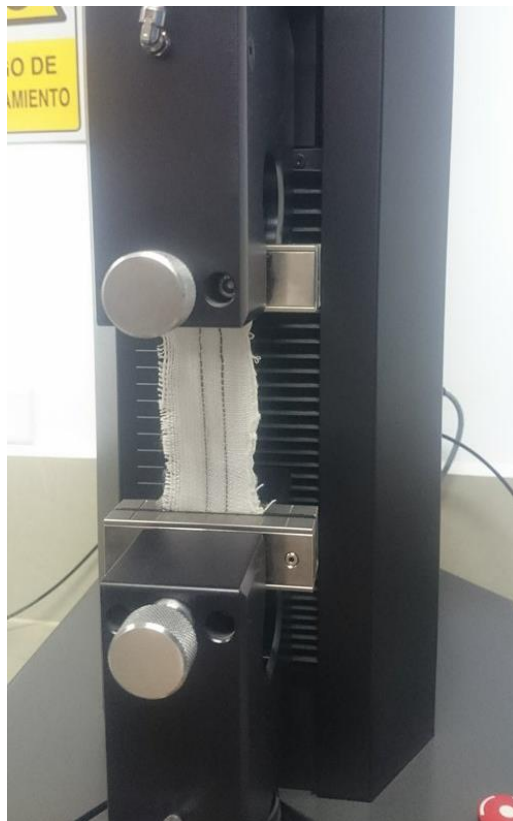
Fig. 66 Prueba N°3 Resistencia a la tracción Elaborado por: Tamia C. Lima Lema
