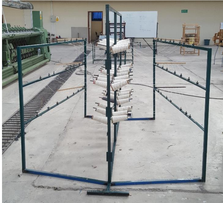
Fig. 40 Urdición: FILETA Elaborado por: Tamia C. Lima Lema
