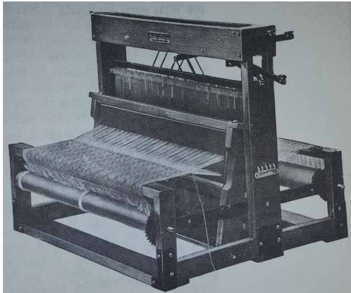
Fig. 30 Telar de lanzadera 4 marcos Fuente: (Wingate, 1987, p:115)
