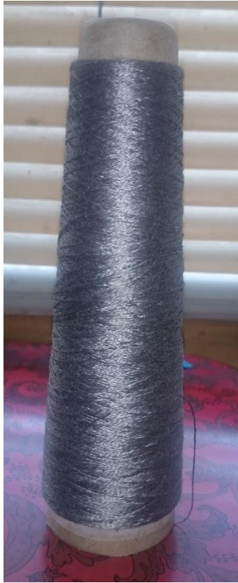
Fig. 38 Hilo Conductor Elaborado por: Tamia C. Lima Lema
