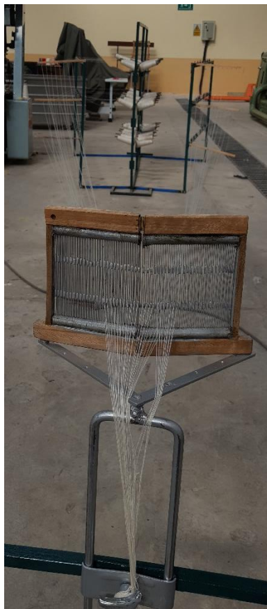
Fig. 41 Urdición: PEINE EXTENSIBLE Elaborado por: Tamia C. Lima Lema
