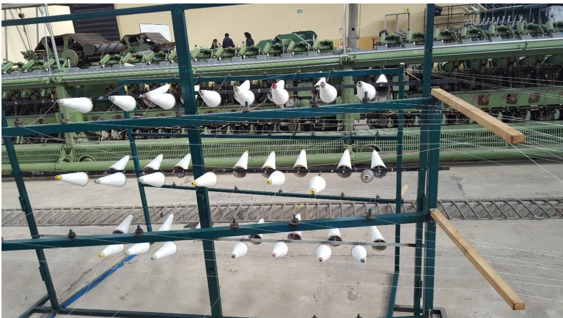
Fig. 37 Hilos de Poliéster - Hilo Conductor Elaborado por: Tamia C. Lima Lema
