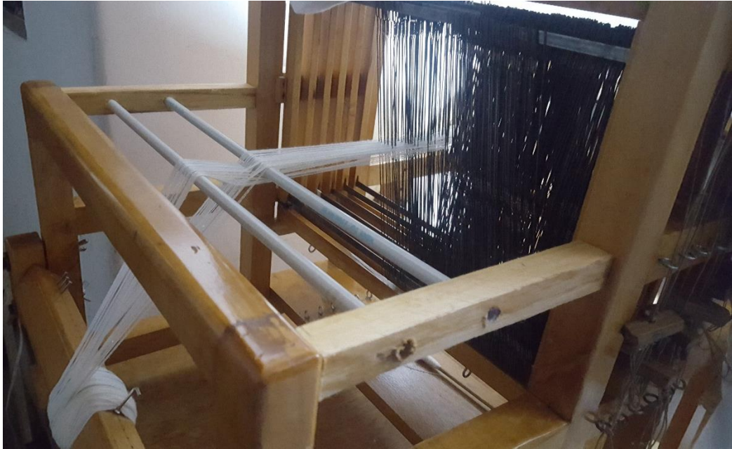
Fig. 50 Remetido: Elaboración Muestra N°1 (algodón – poliéster – hilo conductor) Elaborado por: Tamia C. Lima Lema
