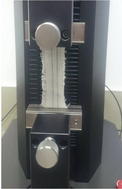
Fig. 63 Prueba N°1 Resistencia a la tracción Elaborado por: Tamia C. Lima Lema
