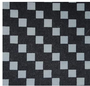
Fig. 5 Tejido Plano: Sarga irregular – surcos de parte superior izquierda a parte inferior Fuente: (Wingate, 1987, p:127)
