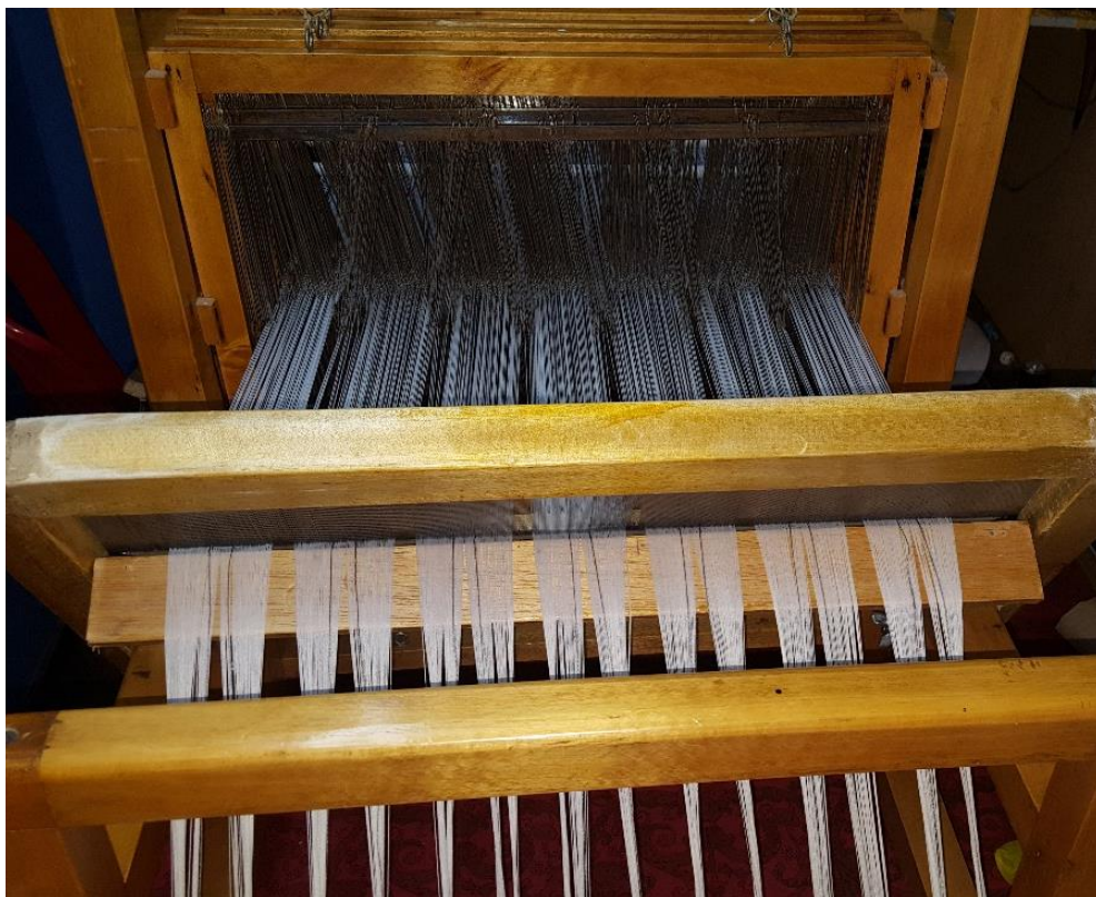
Fig. 53 Remetido/paso por el peine Elaborado por: Tamia C. Lima Lema
