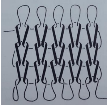
Fig. 23 Tejido de punto por trama Fuente: (Barrera, 1984, p:30)
