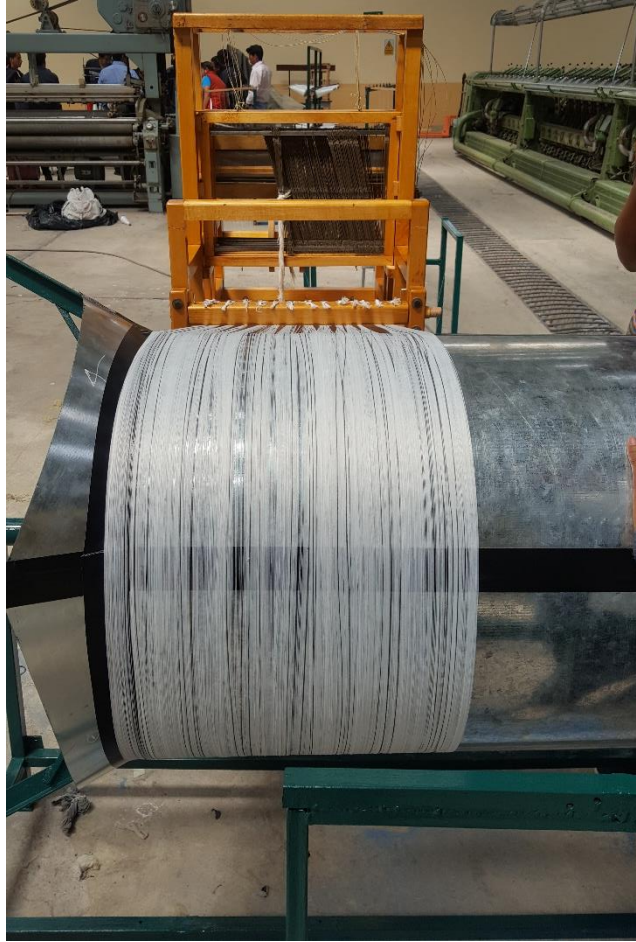
Fig. 48 Bota (urdición), fajas, telar vertical Elaborado por: Tamia C. Lima Lema
