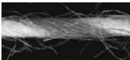
Fig. 29 Multifilamentos del metal torcidos junto al hilo Fuente: (Pla, 2016, p:22)
