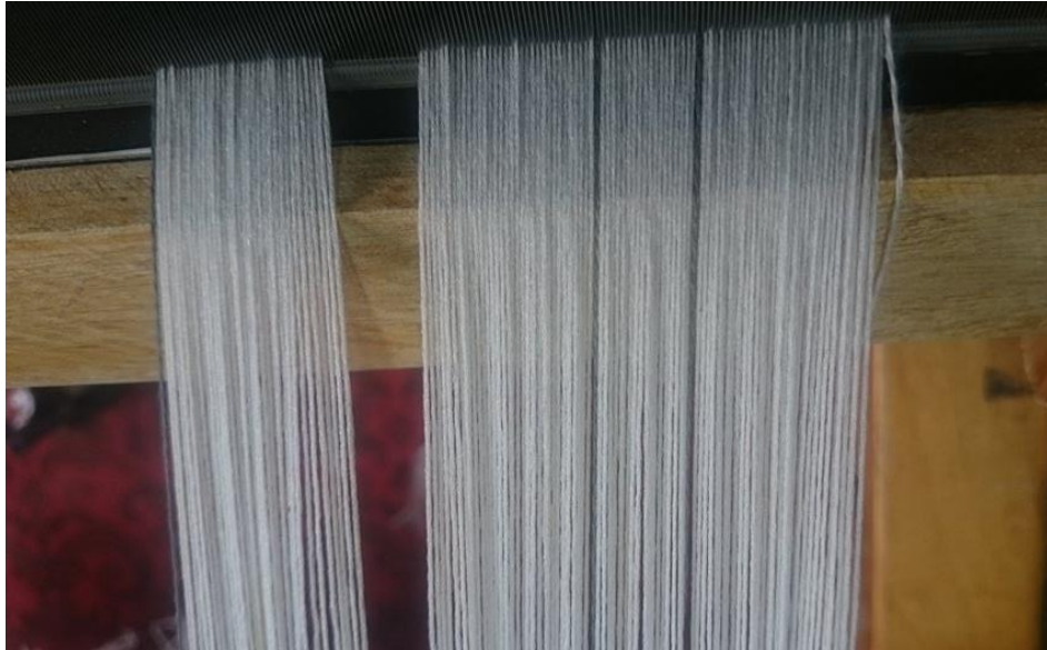
Fig. 52 Hilos de urdimbre (Poliéster - Conductor) Elaborado por: Tamia C. Lima Lema
