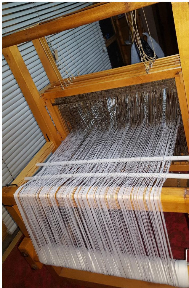
Fig. 51 Urdimbre: cruceros, remetido 7 Tejidos conductores Elaborado por: Tamia C. Lima Lema
