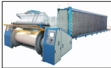
Figura 3: Máquina urdidor directo Fuente: (Pratap & Verma, 2017, pág. 56)
