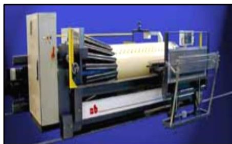
Figura 43. Urdidor seccional con tambor con ángulo de conicidad ajustable Fuente: (Ateliers de Belmont , s.f.)
