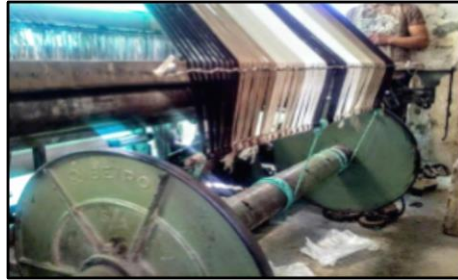
Figura 9. Inicio del plegado- Urdimbre sobre el rastrillo atada a las cuerdas del plegador Fuente: Los autores
