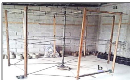
Figura 2: Urdidor de Tambor, (a) travesaño con tres clavijas, (b) travesaño con dos clavijas Fuente: Los autores
