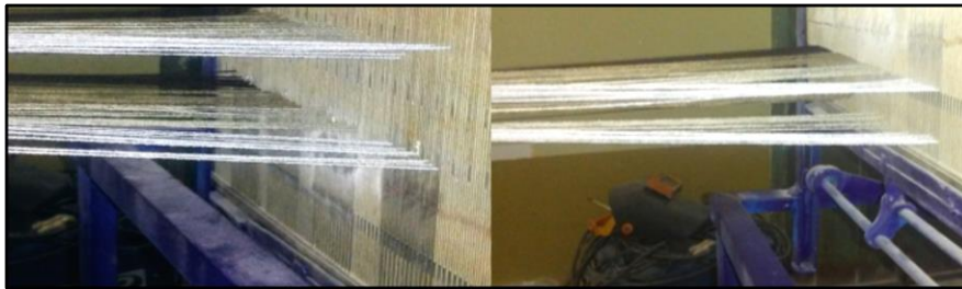
Figura 139: Formación de la cruz de urdimbre Fuente: Los autores
