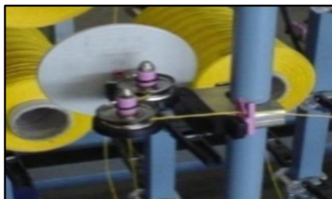
Figura 13. Tensor modelo T-500 Marca Rius Fuente: (RIUS COMATEX, 2017)
