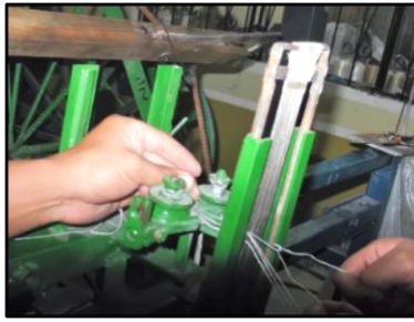
Figura 85: Pasado de hilos por lisos Elaborado por: Los autores
