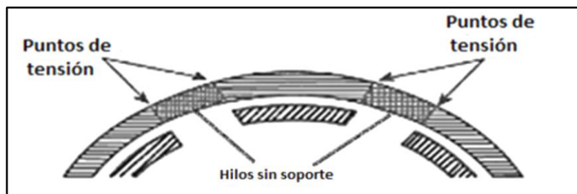
Figura 47. Vista transversal del tambor abierto Fuente: (Banerjee, 2014, pág. 57)
