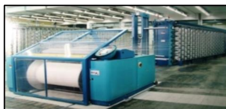
Figura 53. Urdidor Directo Benninger Fuente: ( Thomas Lebherz Textile Machinery, 2017)
