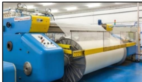
Figura 63. Plegador-Urdidor Directo UNI-EVO Fuente: (COMSAT SPAIN, s.f.)
