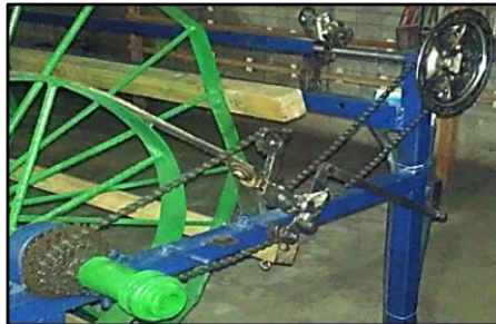
Figura 104: Nuevo mecanismo para el movimiento del portapeine Fuente: Los autores
