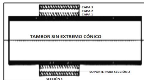
Figura 38. Enrollado de la sección en un tambor sin extremo cónico Fuente: (Banerjee, 2014, pág. 54).
