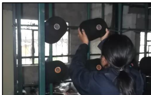
Figura 135: Alimentación o llenado de fileta Fuente: Los autores
