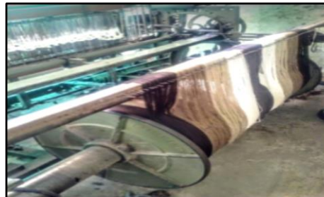
Figura 10. Fin de plegado- Hilos de urdimbres listos para el anudado Fuente: Los autores
