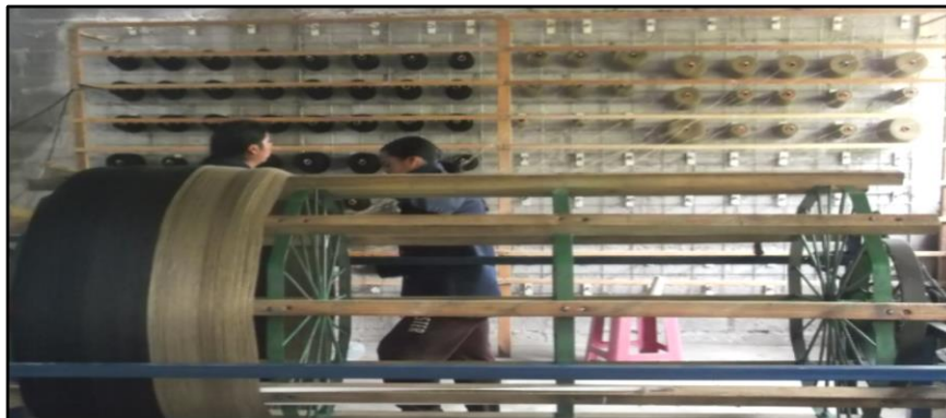
Figura 89. Urdido en el tambor Elaborado por: Los autores
