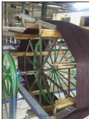
Figura 132: Nuevo mecanismo-variador de ángulo
