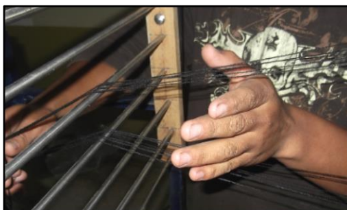
Figura 137: Pasado de los hilos por el separador de niveles
