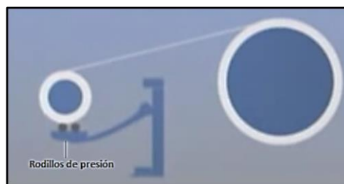
Figura 52. Rodillos de presión accionado para plegado Fuente: (Benninger Textile, 2017)
