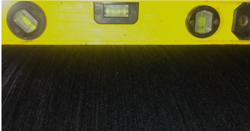
Figura 165. Superficie nivelada del urdido en el tambor
