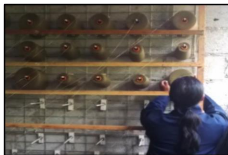
Figura 84. Alimentación o llenado de fileta Elaborado por: Los autores
