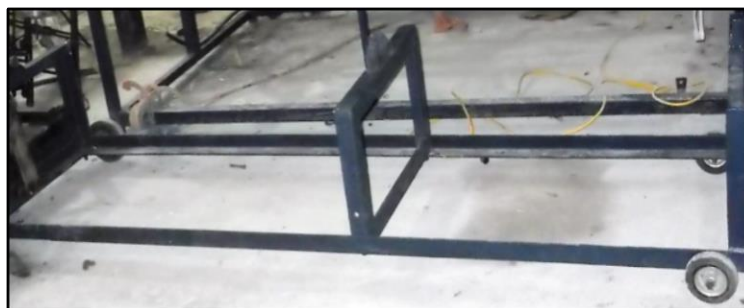
Figura 116: Plegador para distintos anchos de enjullo
