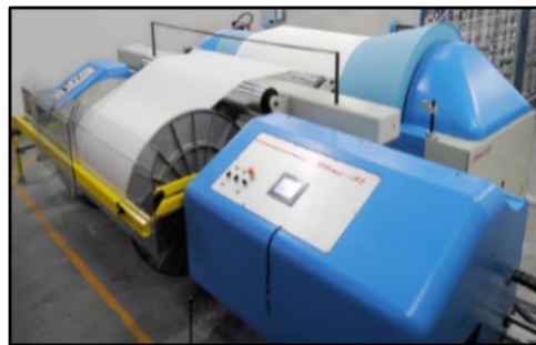
Figura 50: Zona de plegado (Bancada motriz-Plegador) urdidor seccional Comsat modelo UNI-31 Fuente: (COMSAT SPAIN, s.f.)
