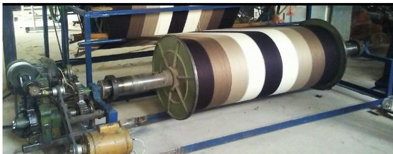
Figura 141: Plegado en el enjullo que ira al telar Fuente: Los autores
