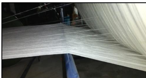
Figura 158: Hilos flojos que salieron de los tensores-proceso de plegado Fuente: Los autores
