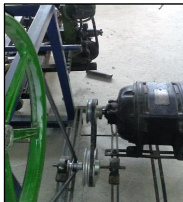
Figura 100. Transmisión de movimiento del motor hacia el tambor Fuente: Los autores
