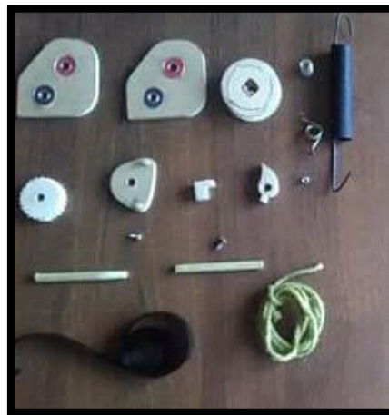
Figura 4.3 Primer prototipo del mecanismo freno – embrague, material mixto (cartón prensado y madera)
