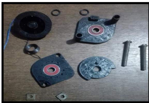
Figura 4.5 Tercer prototipo del mecanismo freno – embrague, material PLA color negro
