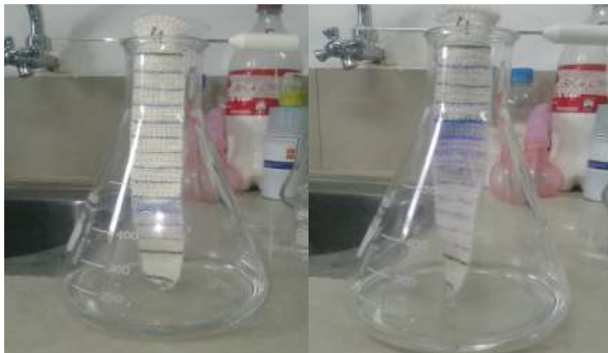
Figura 19 Prueba de absorción de humedad vertical en bambú Vs. algodón
