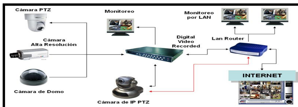
Figura 2. Esquema básico de un sistema de video vigilancia IP.
