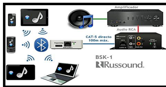
Figura 11. Esquema básico de conexión Bluetooth.
