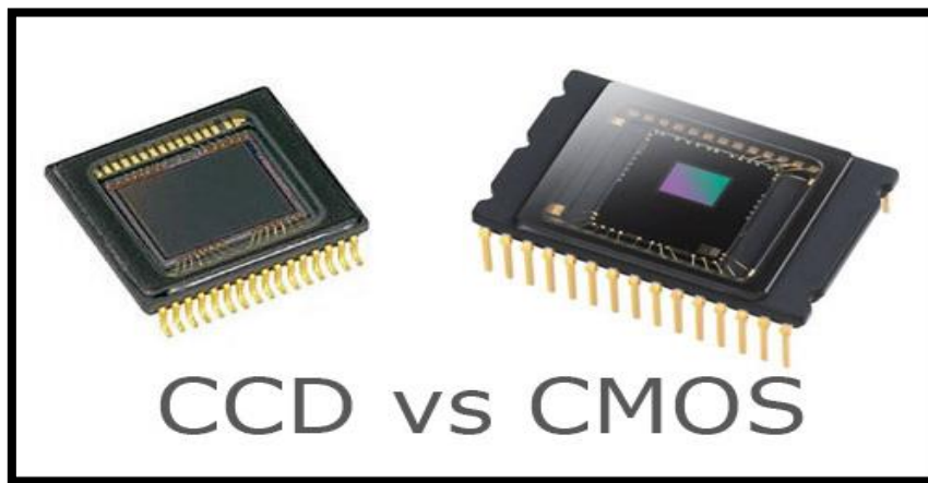
Figura 4. Sensores CCD y sensores CMOS.
