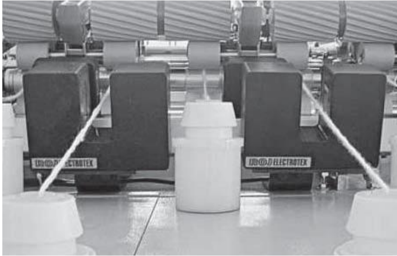
Figura 8. Mecha a la salida del tren de estiraje de la mechera Fuente: Manual Técnico Textil - (Giraldo Martínez, 2015)
