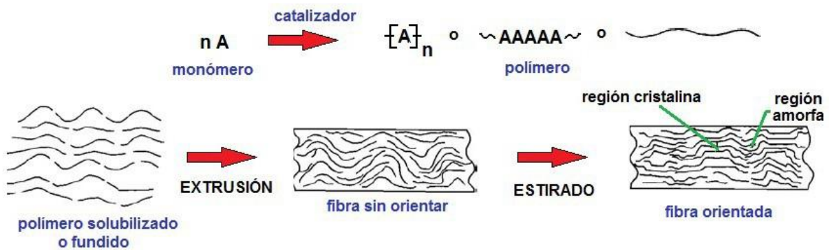
Figura 16. Creación de fibras sintéticas a partir de monómeros Fuente: Cuaderno Tecnológico de Hilatura del Algodón - (Solé, 2012)
