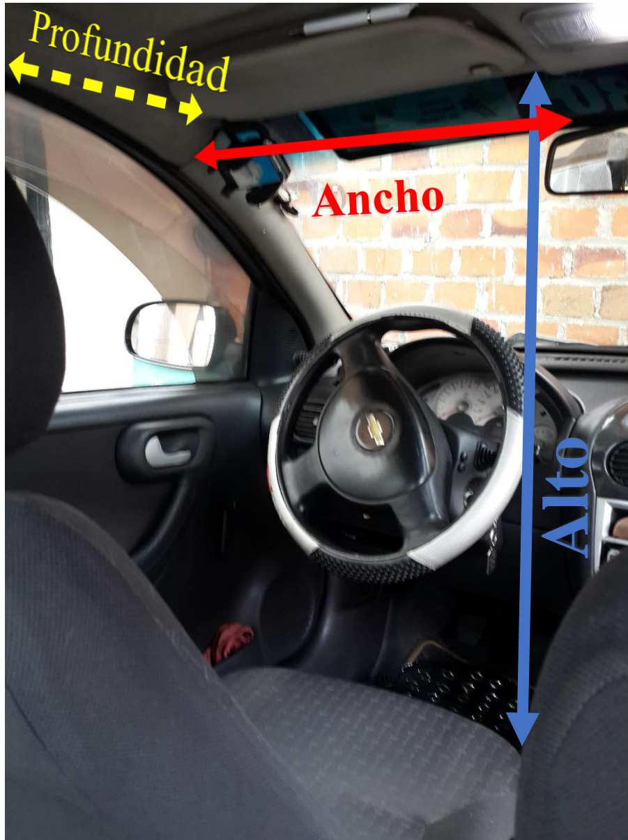
Figura 104. Alto ancho y profundidad para instalar la cámara y el sensor de temperatura.
