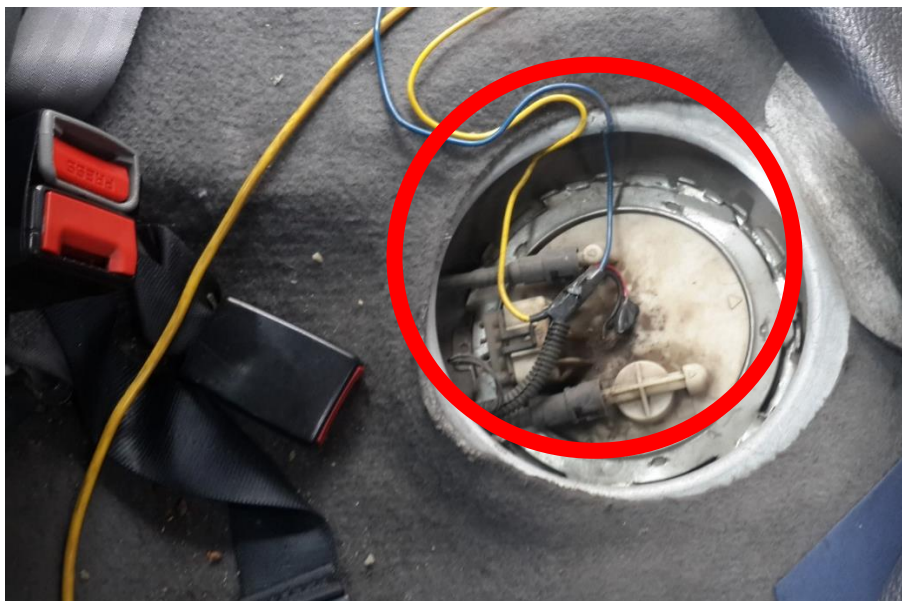
Figura 98. Empalme de los terminales de la cámara de combustible.
