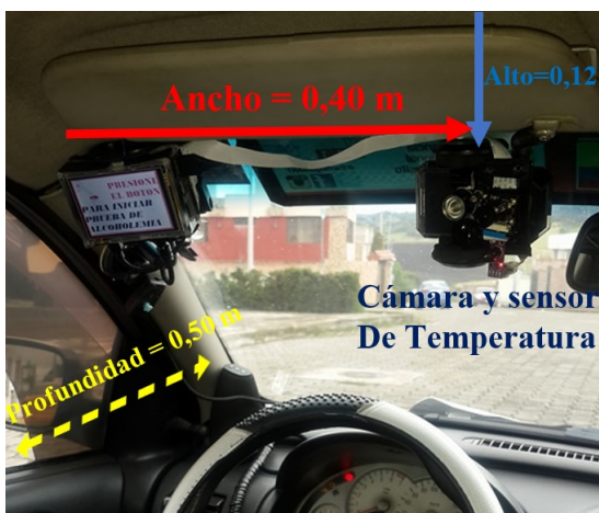
Fig. 27. Alto ancho y profundidad para instalar la cámara y el sensor de temperatura. Fuente: Autoría
