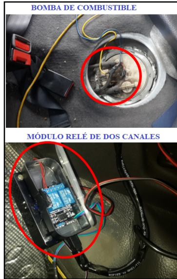
Fig. 19. Empalme de los terminales de la cámara de combustible y conexión del módulo relé que activa o desactiva la bomba de combustible.
