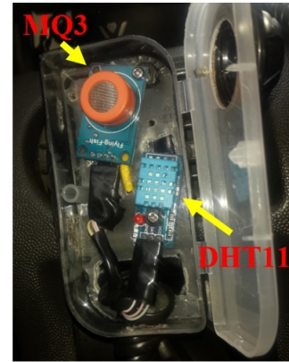
Fig. 10. Montaje del sensor de Alcohol MQ3 y el sensor de Humedad DHT11 y Lectura del nivel de alcohol. Fuente: Autoría
