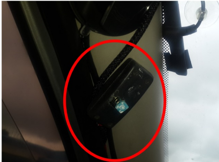
Fig. 26. Montaje del botón de activación del sistema. Fuente: Autoría
