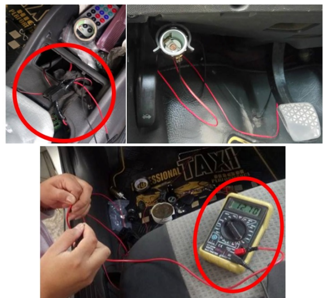
Fig. 25. Empalme los terminales positivo y tierra del Encendedor de cigarrillos y Comprobación del voltaje.
