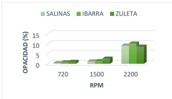
Figura 7. Comparativa de opacidad promedio con biodiésel a diferente altitud y RPM
