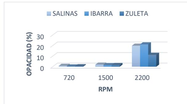
**Figura 6.** Comparativa de opacidad promedio con diésel a diferente altitud y RPM
