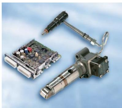
Figura 3. Sistema de inyección UPS [19]
