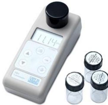
**Figura 23.** Turbidímetro.
