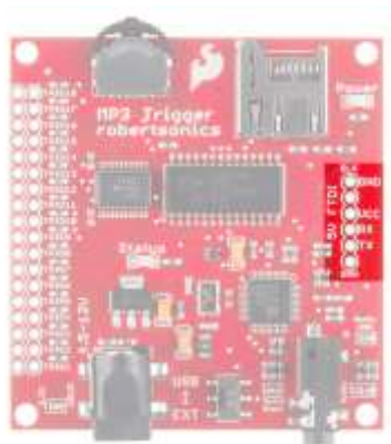
Figura 2. 13 Puerto de comunicación FTDI en el módulo Trigger MP3 (PERFORM, 2014)
