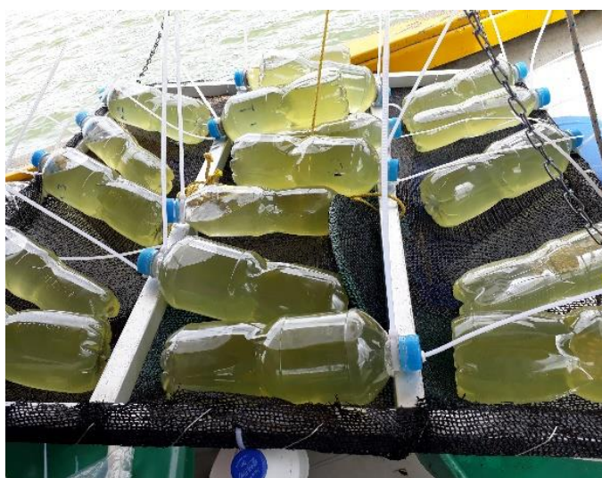
Figura 11. Estructura metálica con botellas de los bioensayos
