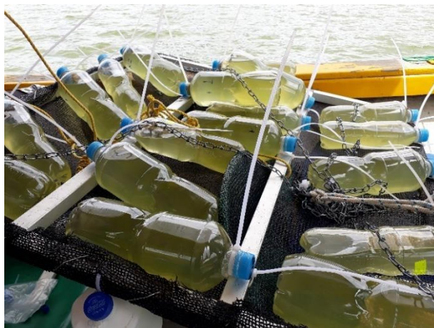
Figura 34. Estructura con bioensayos listo para colocar en el lago.
