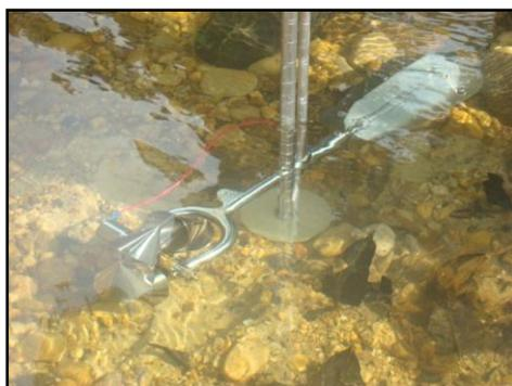
**Fotografía 3.7 Molinete electrónico Rickly Hidrological Co.**
