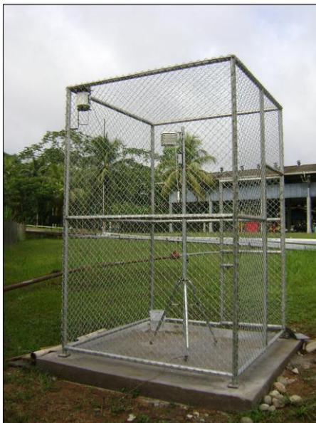
Fotografía 4.12 Estación Meteorológica HOBO ® Micro Station
