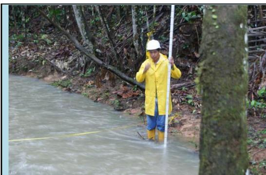
*Aforo método flotador(7)*
