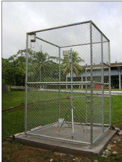
**Fotografía 3.6 Estación Meteorológica HOBO® Micro Estacion**
