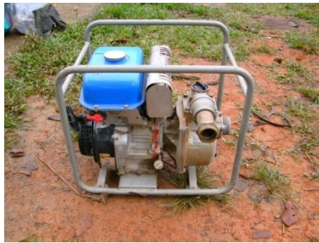
Foto 76: Bomba de agua para lavado
