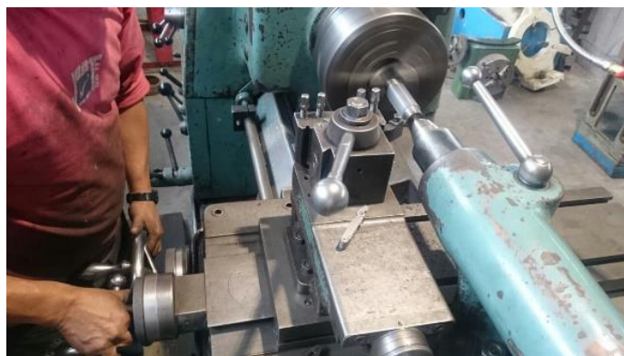
Figura 4.10 Cilindrado donde van los rodamientos
