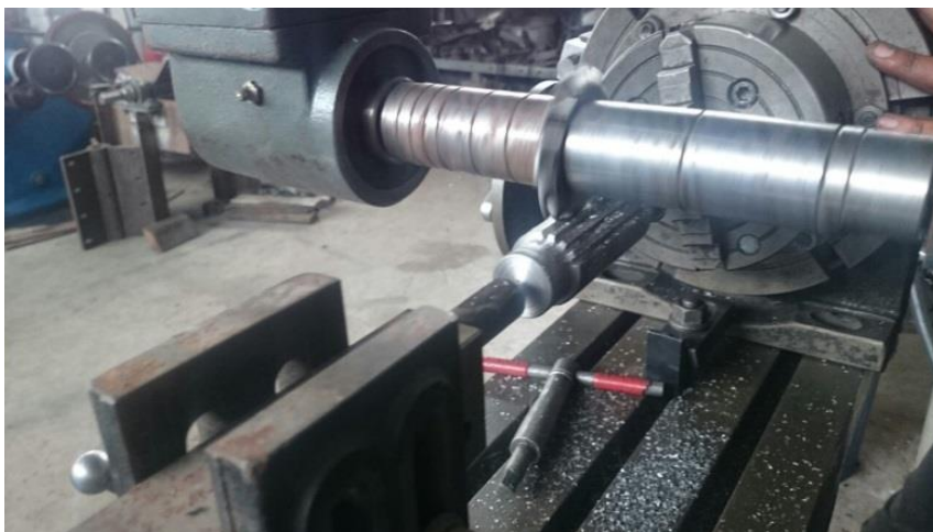
Figura 4.12 Tallado del estriado en la fresadora
