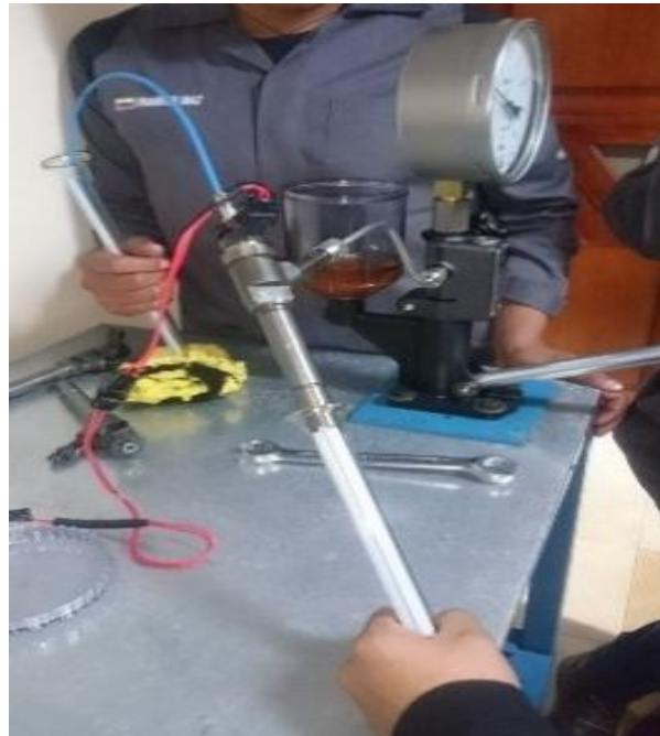
Figura 41. Comprobación inyector con el equipo CRI 200
