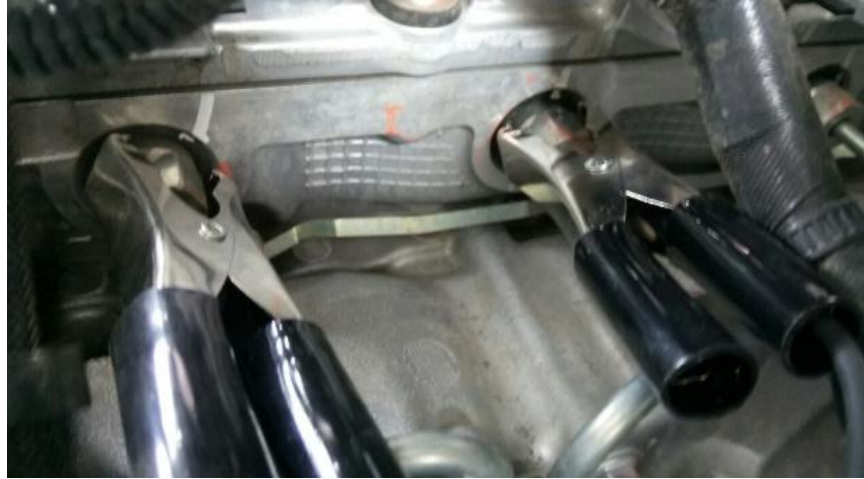
Figura 44. Conexión del estetoscopio al motor
