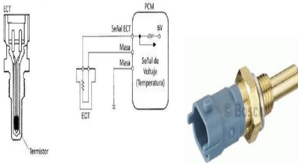
Figura 8. Sensor temperatura de combustible Fuente: (Coral, 2013)
