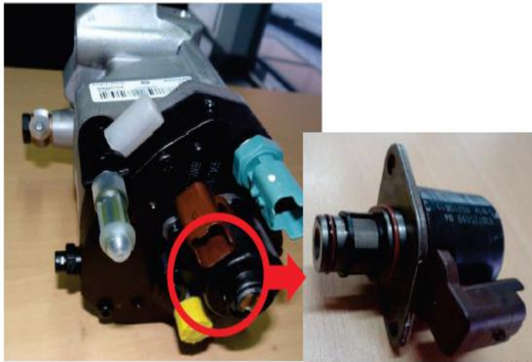
Figura 13. Válvula reguladora de presión Fuente: (Barros & Pulla, 2016)
