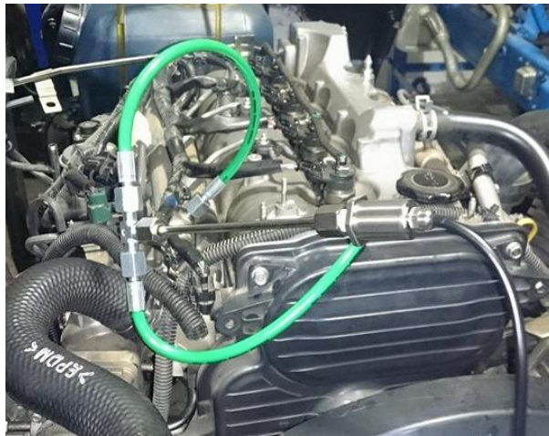
Figura 28. Instalación de equipos para el diagnóstico
