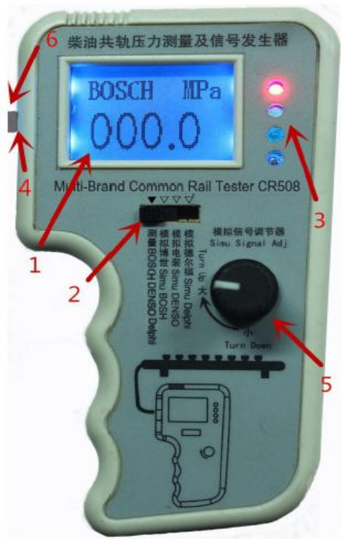
Figura 20. Componentes del Equipo GT - 508 Fuente: (Automotive, 2015)
