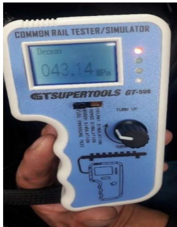
Figura 33. Valores de presión con el equipo de diagnóstico GT - 508
