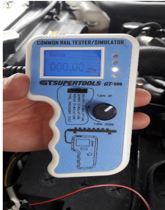
Figura 32. Identificación de selector de diagnóstico equipo GT – 508
