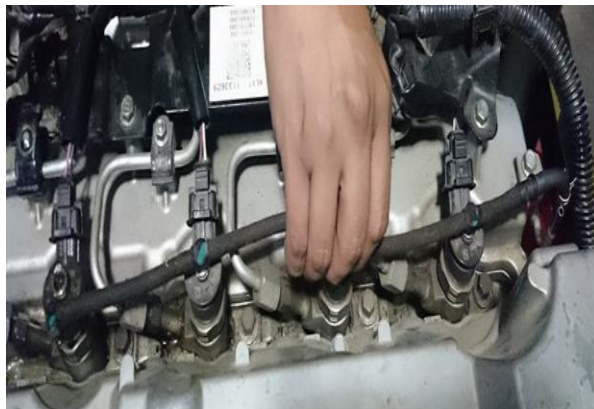
Figura 38. Extracción tubería de retorno de combustible.
