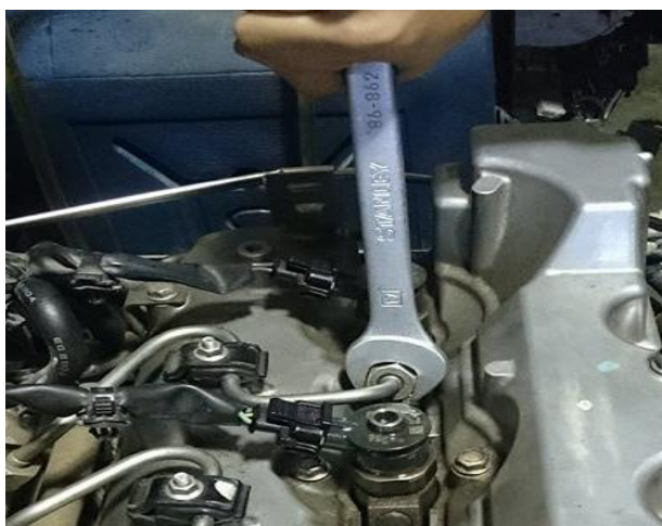
Figura 39. Extracción de cañerías
