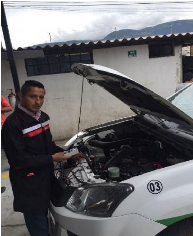
Figura 34. Lectura de mediciones con equipo GT – 508
