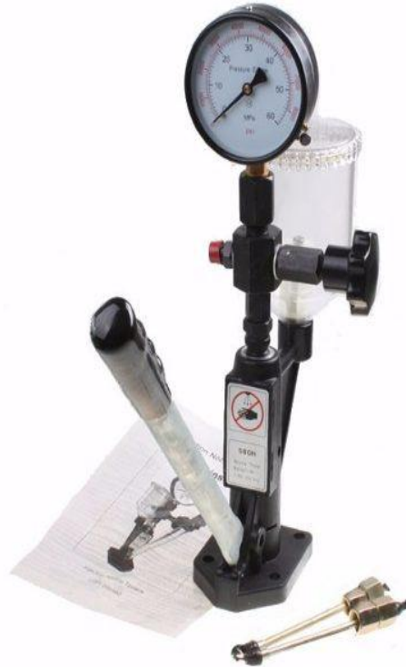
Figura 37. Probador mecánico de inyectores diésel Fuente: (Chavez, 2017)
