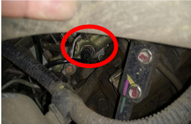
Figura 30. Conexión equipo de diagnóstico CR508
