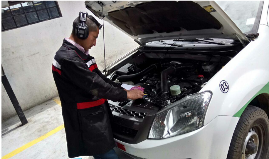
Figura 54. Pruebas de funcionamiento utilizando un estetoscopio.
