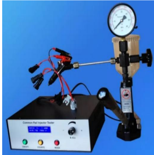
Figura 24. Funcionalidad CRI 200 y probador de inyectores manual Fuente: (DHgate, 2018)
