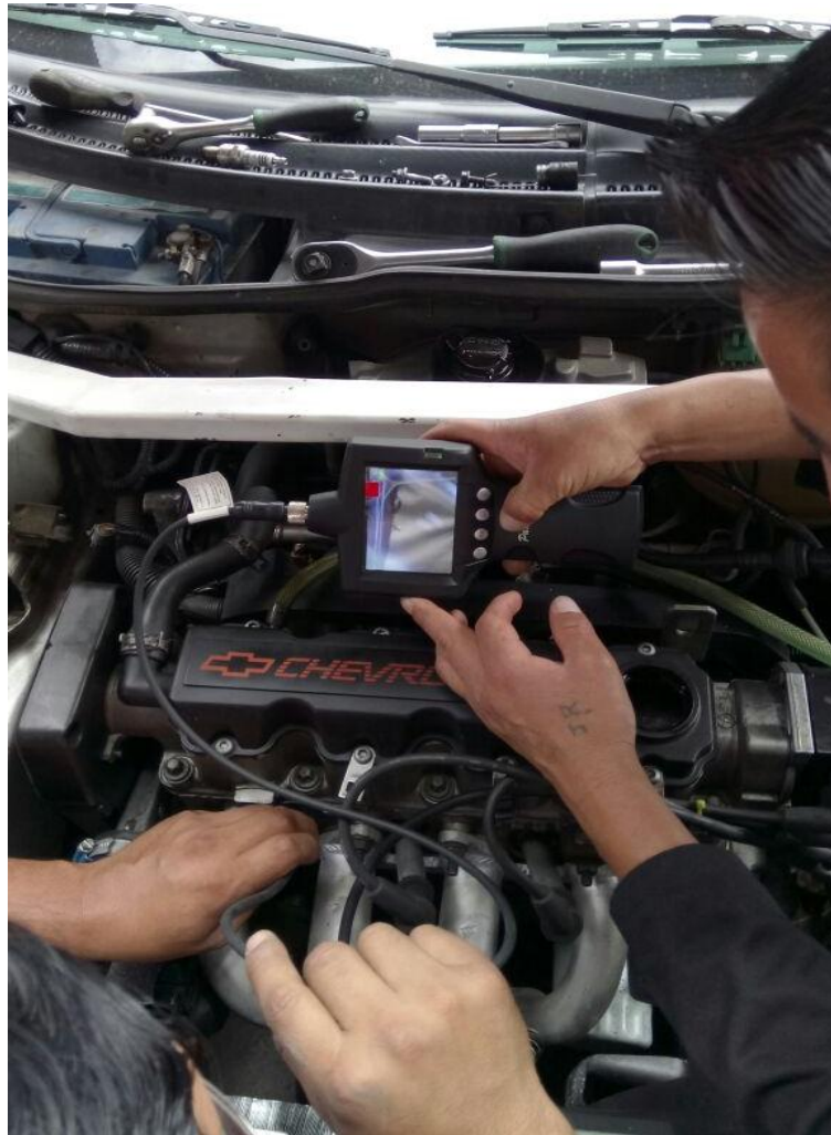
Figura 47. Inspección del cilindro número 1
