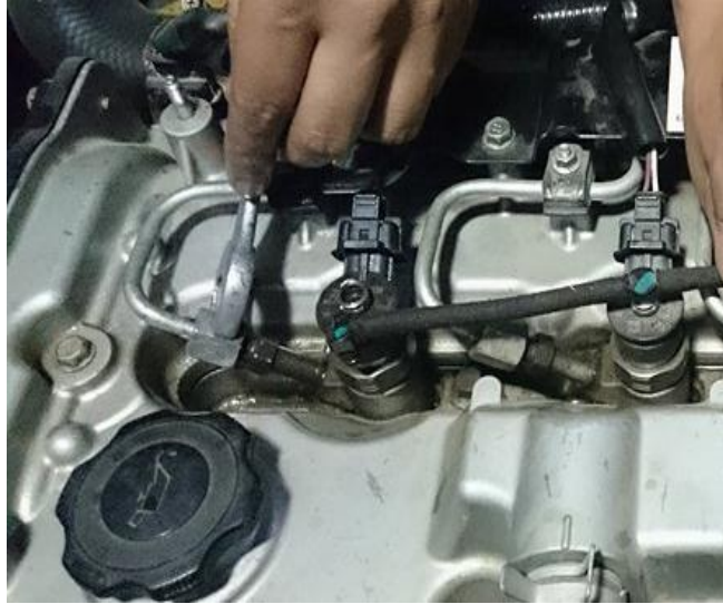
Figura 27. Desmontaje de cañería de alta presión del primer cilindro.
