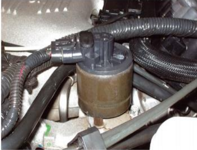
Figura 14. Válvula de recirculación de gases de escape Fuente: (Zamora, 2012)
