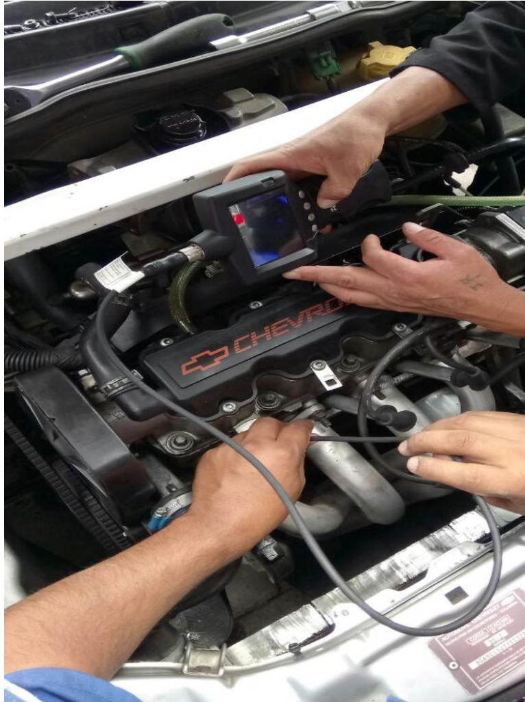
Figura 46. Inspección mediante boroscopio
