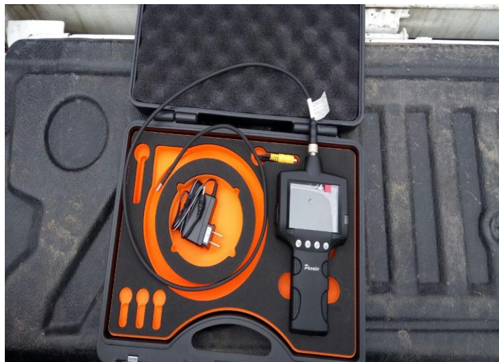
Figura 26. Boroscopio de uso automotriz Fuente: (Tonsom, 2014)
