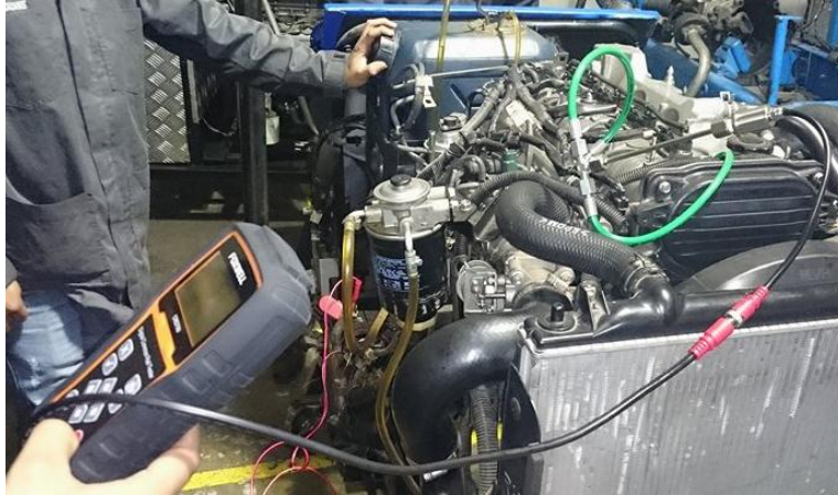
Figura 29. Mediciones de presión con el equipo CRD700
