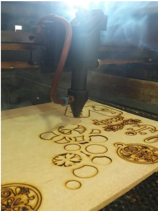
Fotografía 11. Corte de biojoyas a láser
