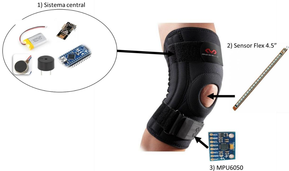
Figura 46. Integración de Hardware (Prototipo VI)
