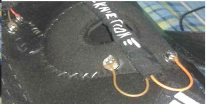
Imagen 3. Conexión del sensor de flexión
