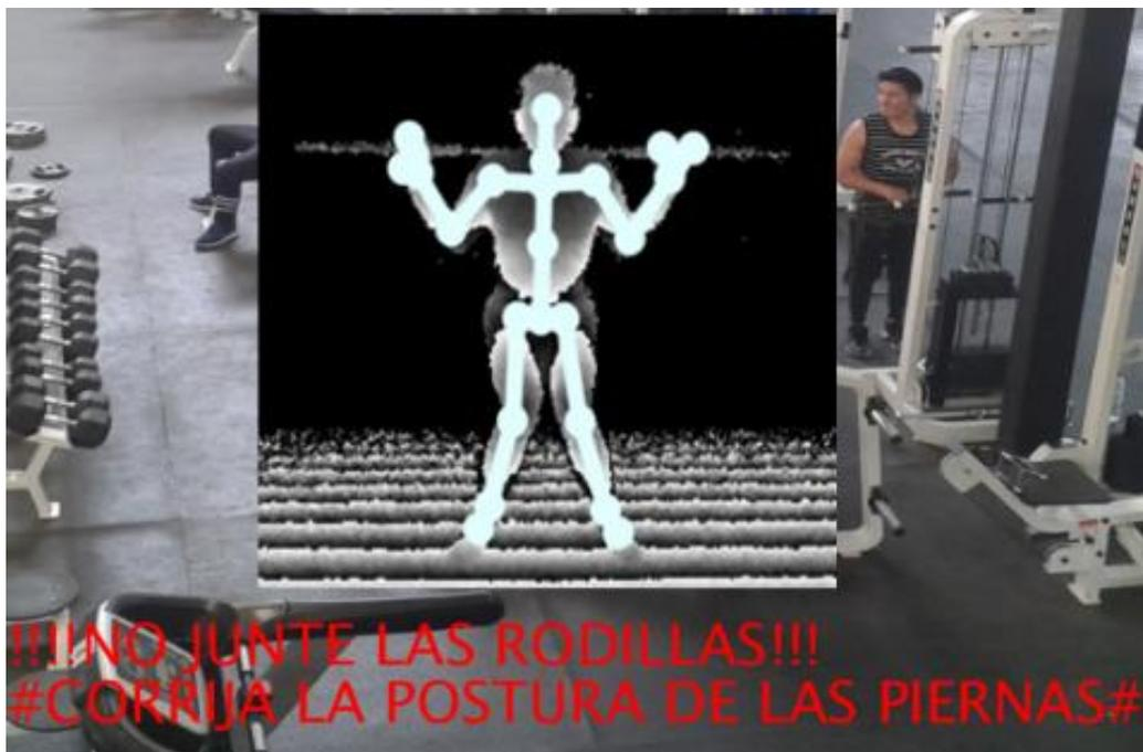
*Figura 72. Prueba de error-Aducción*
