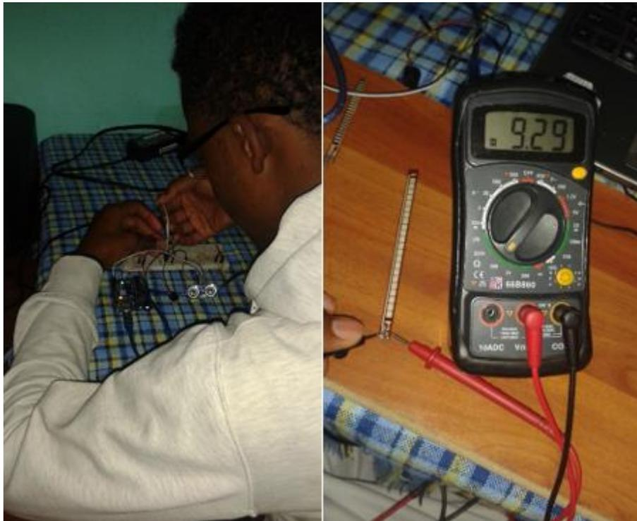
Figura 83. Medida de resistividad de sensor de flexión
