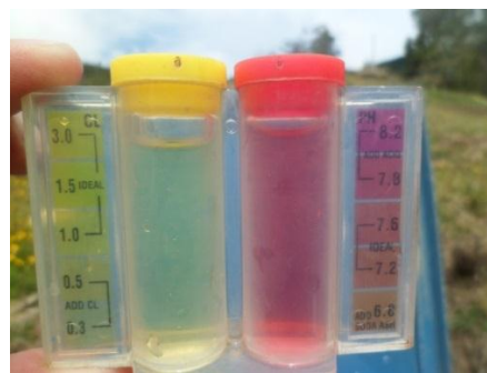
Fotografía 28. Monitoreo de Cl residual y pH
