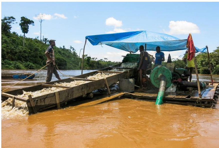
Figura 7. Método Hidráulico (dragas)
