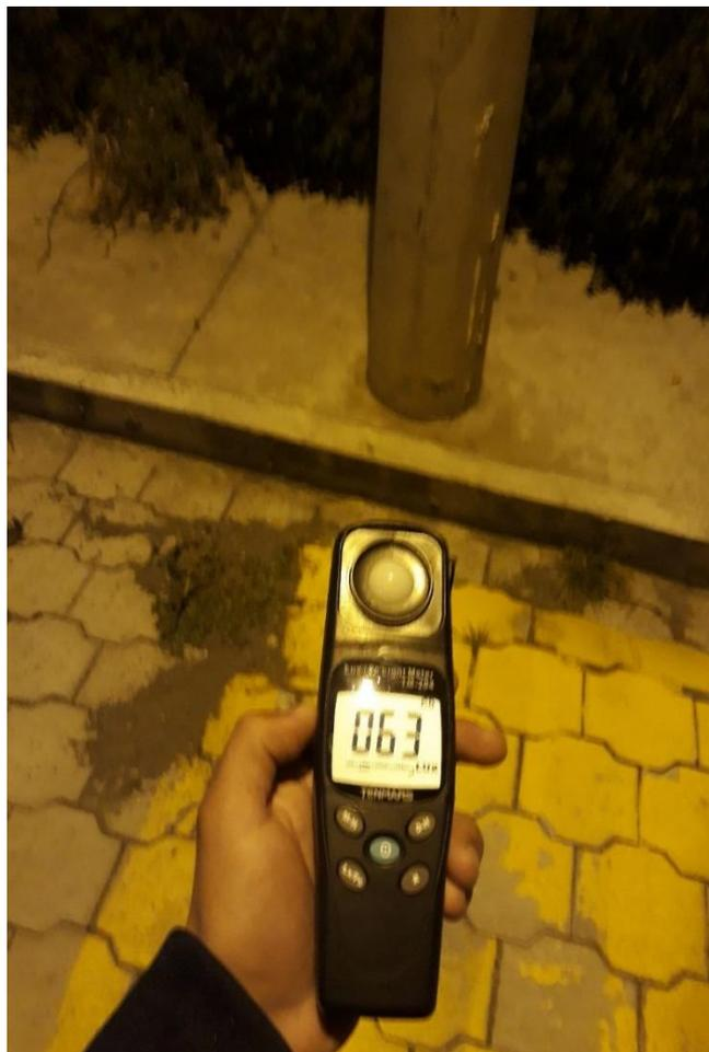
**Figura N° 23** Medición luxómetro lámpara vapor de sodio escala 2000
