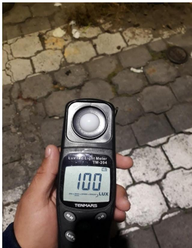
**Figura N° 22** Medición Luxómetro lámpara led con escala de 2000
