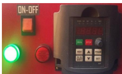
Figura 35. ON OFF e Interface motor herramienta.
