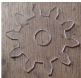
Figura 54. Prueba de mecanizado en acrílico.
