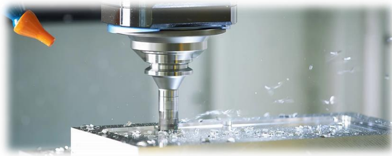
Figura 7. Fresado por vaciado.
