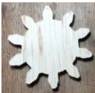
Figura 52. Prueba de mecanizado en madera.
