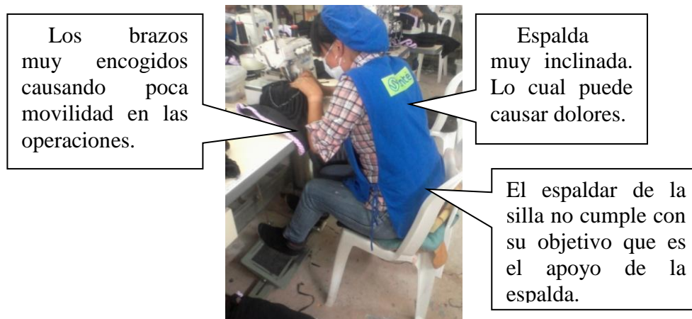
Ilustración 22 Ejemplo de posición incorrecta que adoptan las operarias
