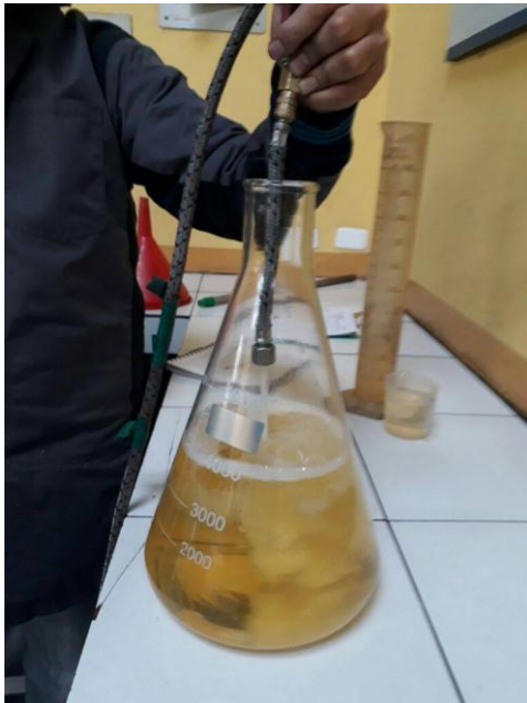
Figura 2. 3 Comprobación del consumo de combustible
