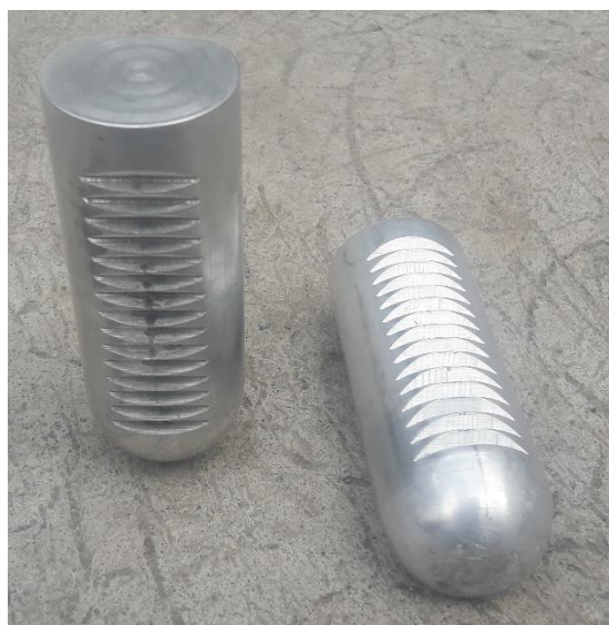
Figura 3.27. Cilindros dentados con punta redondeada acabados después de ser maquinados y moldeados.
