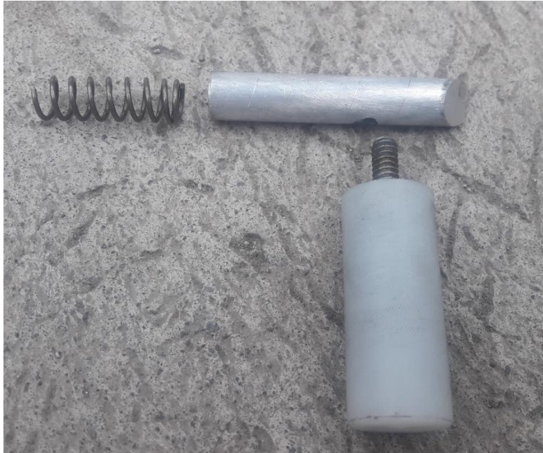
Figura 3.28. Seguro y resorte de presión encargado de retener a los cilindros dentados en la posición deseada prohibiendo el movimiento vertical de los mismos.
