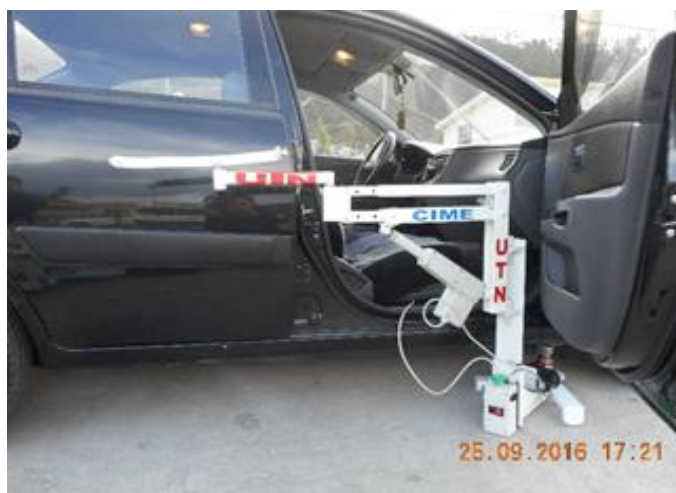
Figura 2. Base portátil para grúa de traslado de personas con capacidad motriz entre silla de ruedas y automóvil. (Conterón, 2016)
