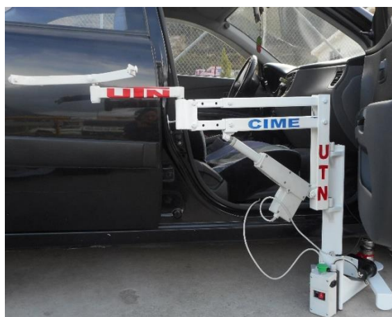
Figura 3.6. Dispositivo de traslado ensamblado y enganchado al vehículo correctamente. (Pineda, 2016)
