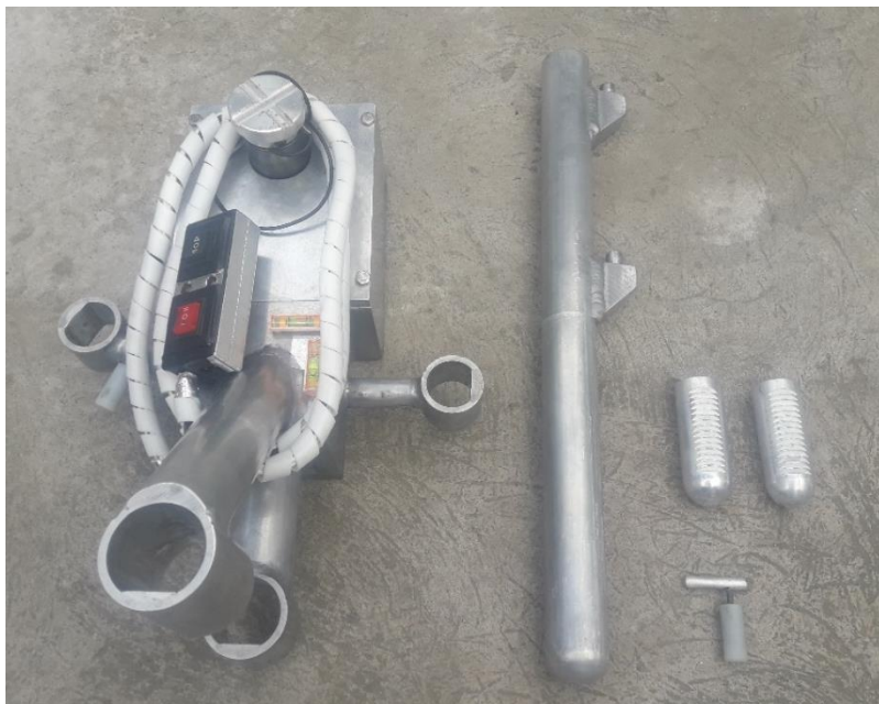
Figura 3.29. Base portátil desmontada en todas sus piezas removibles.
