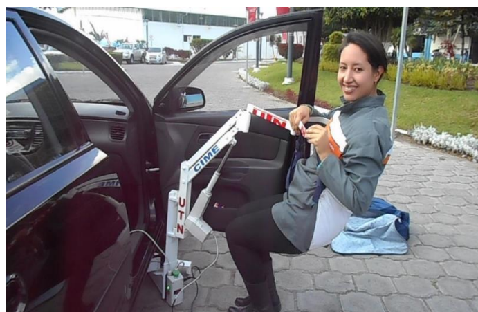
Figura 3.7. Persona con arnés enganchada al dispositivo de traslado. (Pineda, 2016)
