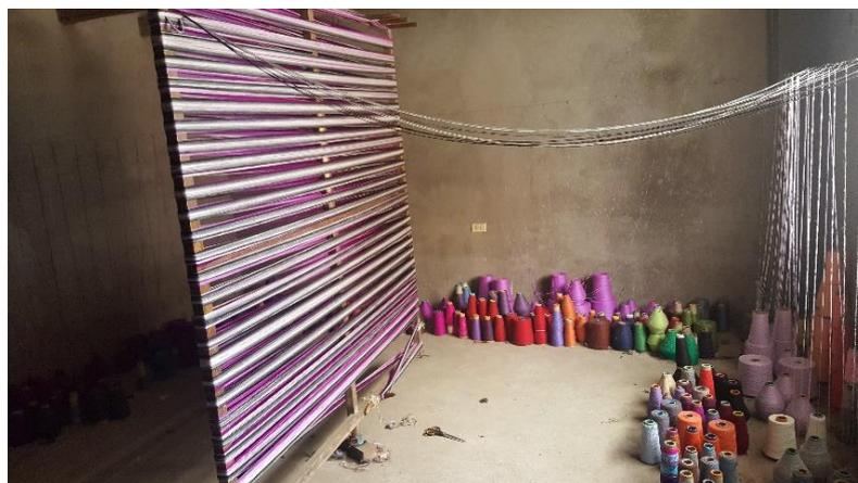
Figura 8. Urdido seccional vertical
