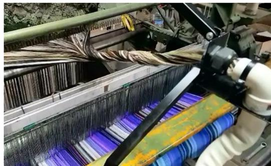
Figura 81. Mecanismo de sujeción de urdimbre en el telar Picañol
