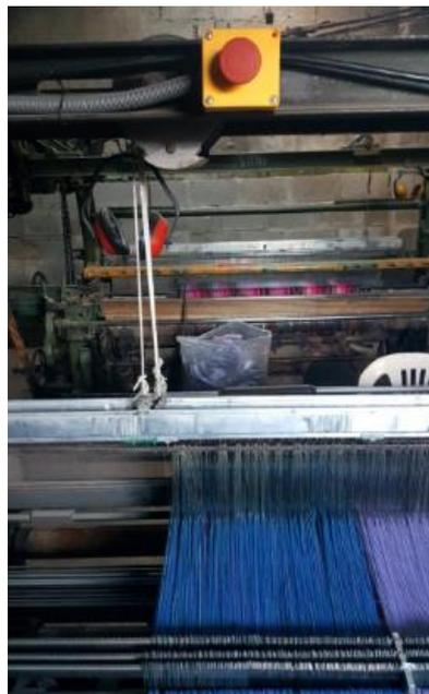
Figura 63. Botón de paro de emergencia instalado en la parte posterior del telar Northrop
