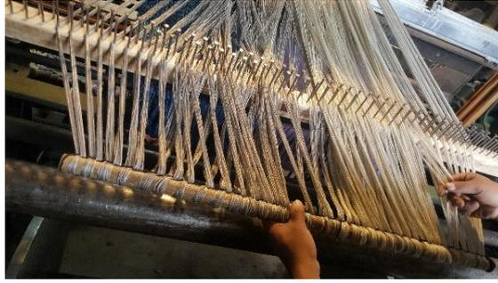
Figura 82. Colocación de urdimbre en guías del rastrillo.
