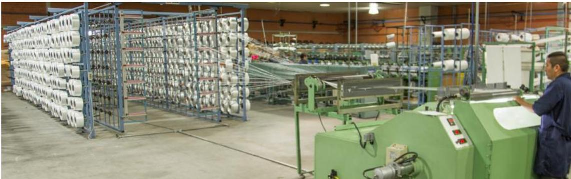
Figura 6. Filetas en el proceso de urdido. Fuente: FLEXICO, México (2018)
