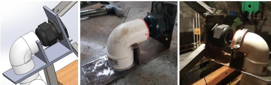
Figura 70. Fabricación de base de prensaestopa de sujeción
