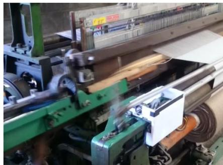
Figura 78. Momento en que se acciona el freno del telar
