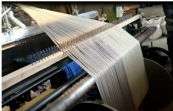
Figura 83. Accionamiento del mecanismo de enrollamiento de urdimbre en el telar Northrop
