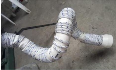
Figura 71. Espiral guía fabricado en PVC por moldeo con calor
