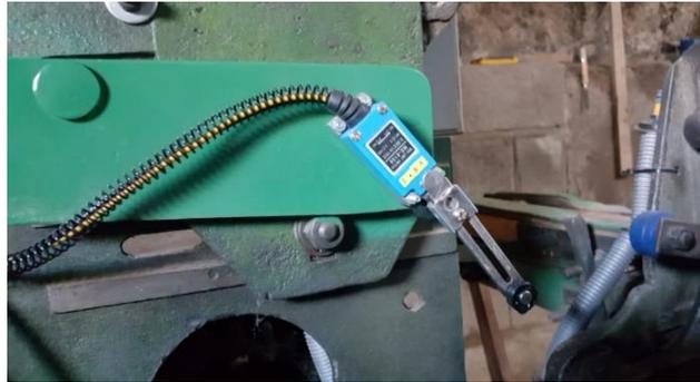
Figura 67. Final de carrera del batán y tope de nylon
