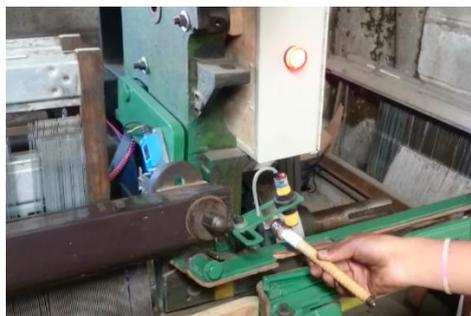
Figura 79. Luces piloto activadas por ausencia de hilo de trama en lanzadera
