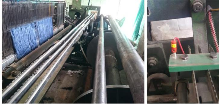
Figura 57. Barra bimetálicas montadas sobre bases recicladas. Borneras de conexión
