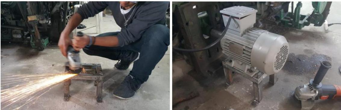
Figura 74. Fabricación de base del motor trifásico
