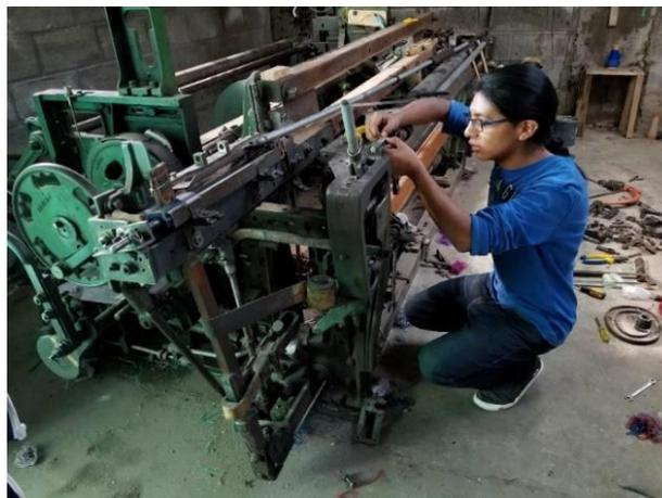
Figura 66. Instalación del mecanismo de leva-seguidor
