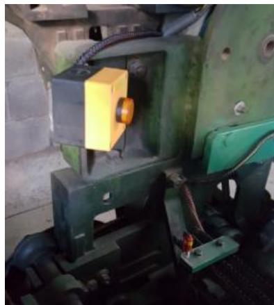
Figura 59. Lámpara de aviso de rotura de hilo de urdimbre
