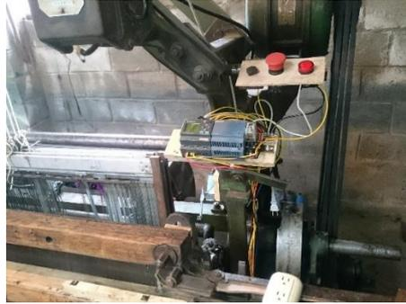
Figura 77. Paro de emergencia en etapa de prueba en el telar Northrop
