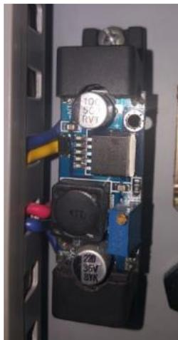
Figura 56. Convertidor Buck LM2596 con aislamiento plástico en sus extremos
