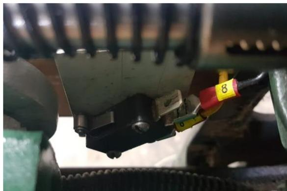
Figura 68. Final de carrera instalado junto a la leva de aluminio
