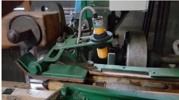
Figura 60. Sensor fotoeléctrico instalado en la caja del batán
