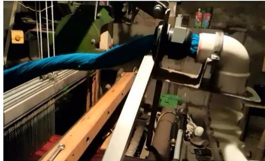
Figura 80. Mecanismo de sujeción de urdimbre en el telar Northrop
