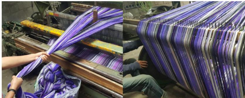
Figura 10. Proceso de enrollamiento manual
