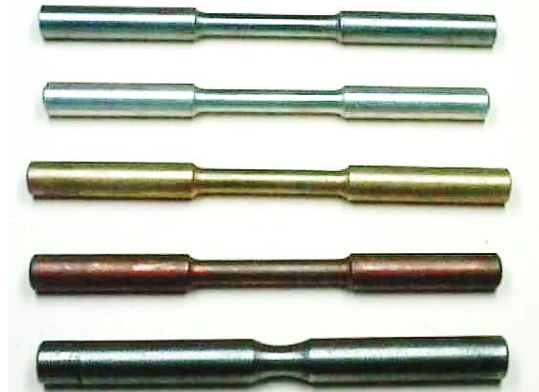
Figura 7: Probetas para ensayos a tracción de diferentes materiales
