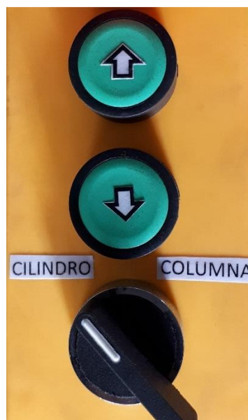
Figura 23: Pulsadores subir y bajar cilindro y selector (máquina)
