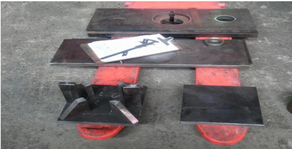
*Figura 43.* Piezas de geometría plana salidas de la cepilladora.
