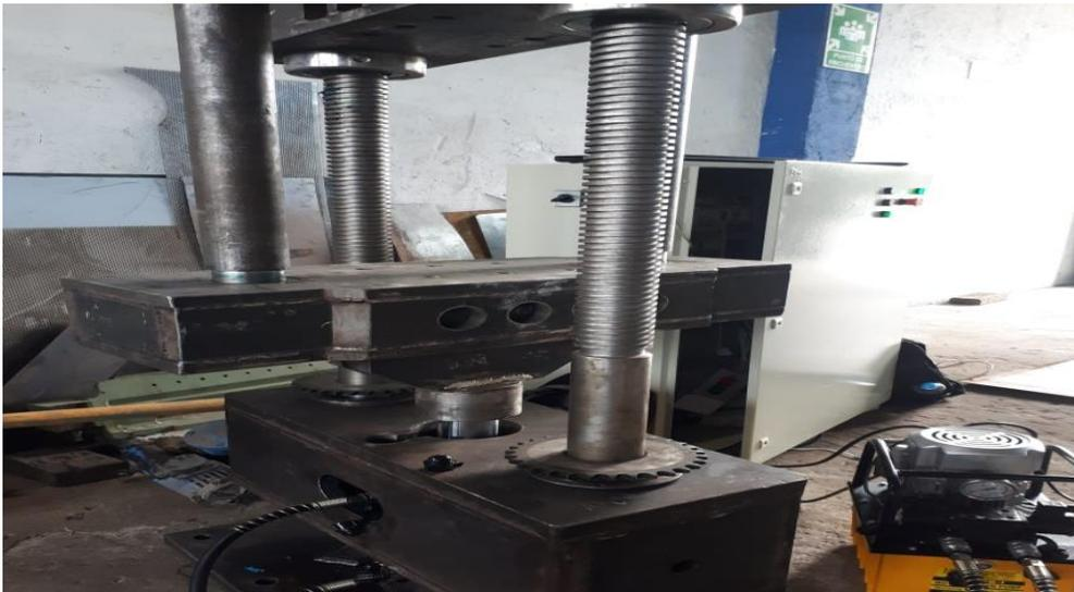
*Figura 57.* Instalación entre la bomba y el cilindro hidráulico.
