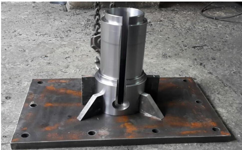
Figura 50. Camisa interna terminada y nervios de refuerzo.
