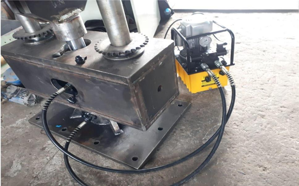
*Figura 56.* Cilindro alojado en la base terminada.
