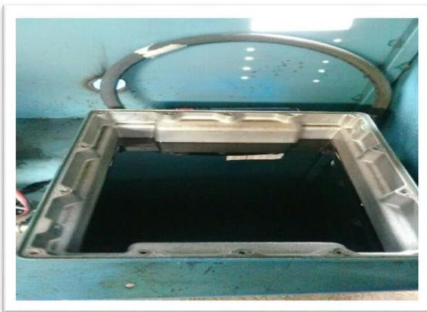
*Figura 41.* Depósito de aceite de la bomba.
