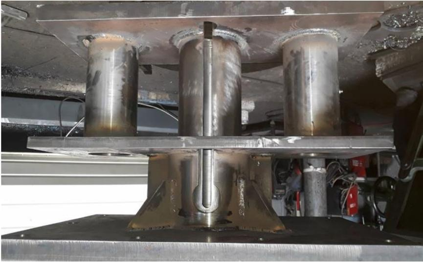
*Figura 52.* Soldadura de todos los elementos que conforman la base del cilindro.
