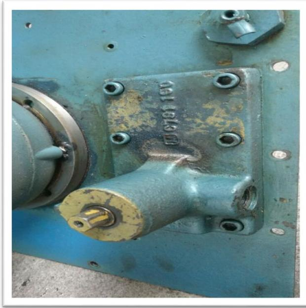
*Figura 39.* Base que aloja el motor y se ensambla con la bomba de aceite.
