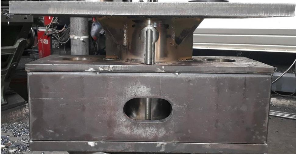
*Figura 54.* Soldadura de tapas de refuerzo de la base.
