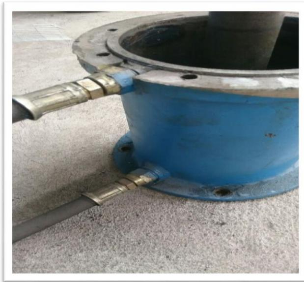
*Figura 37.* Cilindro hidráulico de doble efecto, desmontado de la máquina de ensayos con materiales, donada a la facultad.
