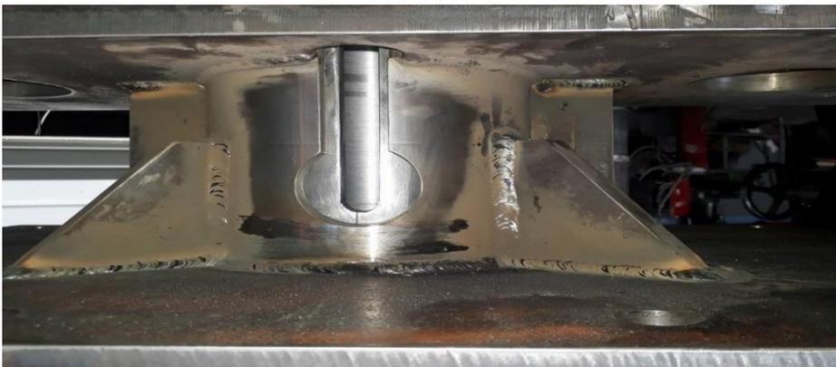
*Figura 53.* Soldadura de nervios, camisa externa e interna a la placa base.
