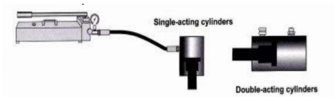
**Cilindros de acción simple:** Colocar el cilindro de modo que el émbolo esté apuntado hacia abajo y el cilindro más bajo que la bomba. Extienda y retraiga completamente el cilindro 2 o 3 veces.
