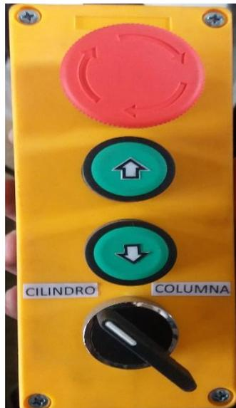
*Figura 29: Representación de los botones para controlar la posición de la bomba y motor (Tablero)*
