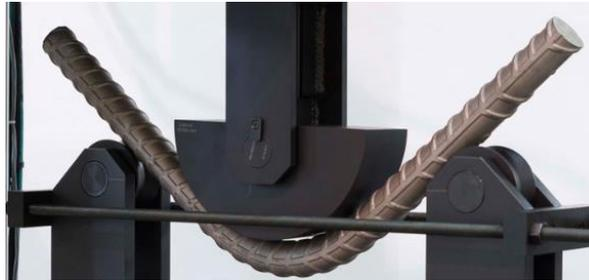
*Figura 12: Método de ensayo a flexión de una varilla (circular) basada en la norma ASTM A370*
