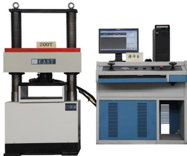
*Figura 1: Máquina para ensayos de compresión de concreto.*
