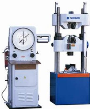
**Figura 1. Máquina universal de ensayo hidráulica**
