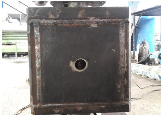
Inyectar grasa al sistema de rodamientos alojados en el bocín por medio del graseo dispuesto en las caras laterales del bloque base. Utilizar una bomba engrasadora.
