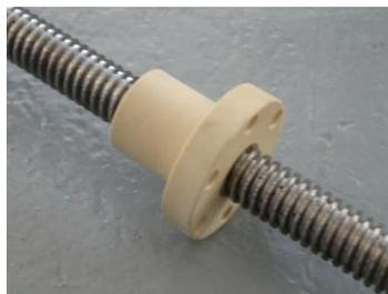
Figura. 2.16. Tornillo de potencia. (Gonzales, 2011)
