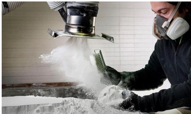
*Figura. 1.3. Impresión por inyección de aglutinante. (C, 2016)*
