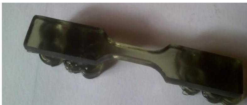
*Figura. 3.6. Calidad de la impresión de la probeta.*
