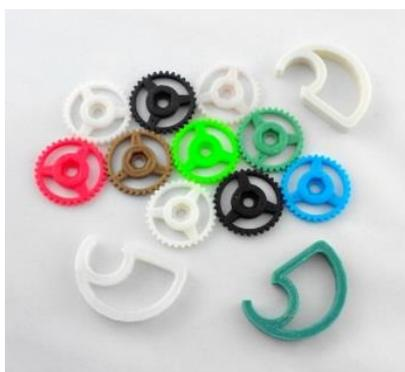
*Figura. 1.1. Piezas impresas con material PLA y ABS. (Ferrer, 2014)*
