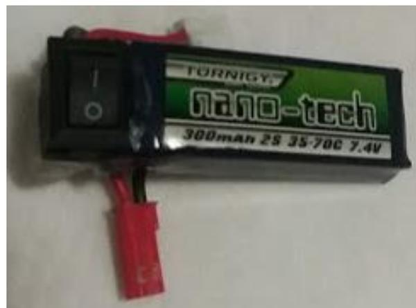
*Figura 31.* Batería de 7,4 voltios adaptada para ser usada con la placa Arduino UNO
