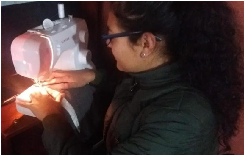
*Anexo 15.* Ensamblaje del tejido conductor con el delantero de la camiseta en máquina recta.
