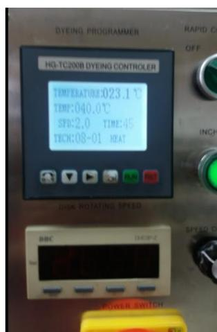
*Anexo 8.* Programa de autoclave para la prueba de lavado acelerado
