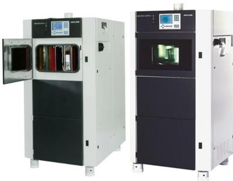
*Figura 27. Máquina para ensayos textiles de oposición a la luz*
