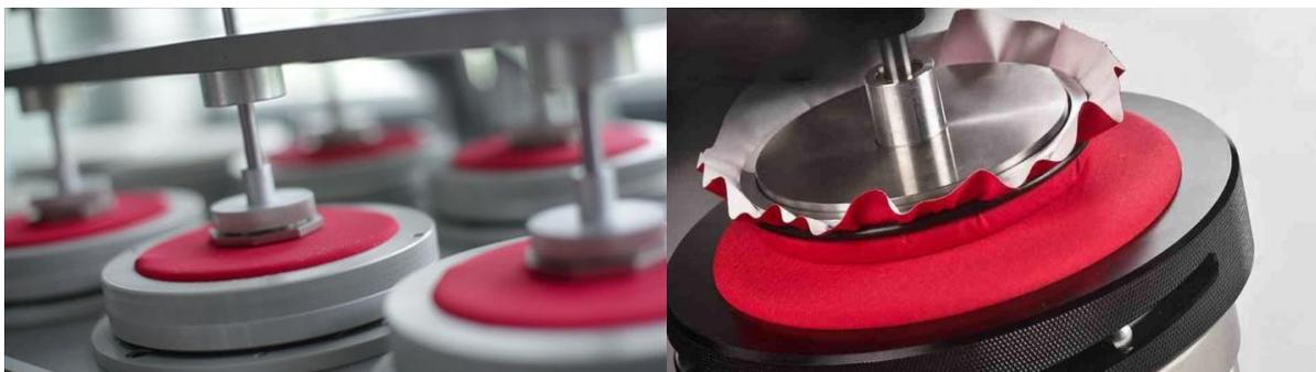
*Figura 26.* Detalle de los discos usados para realizar el test Martindale.
