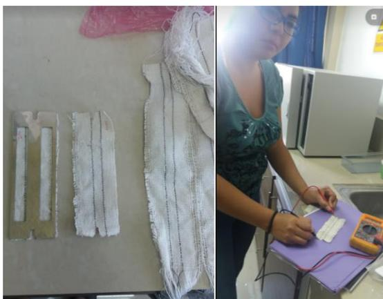
*Anexo 9.* Corte y medición de probetas para la prueba de oposición a la luz.
