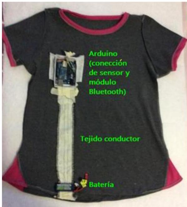
*Figura 32.* Vista del revés de la camiseta. Distribución de los componentes electrónicos.
