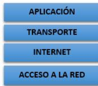
Figura 3. Capas del protocolo TCP/IP Fuente: (Tommaso, 2009)
