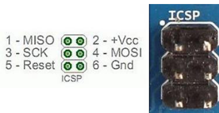
Figura 44. Distribución de pines del bus ICSP Fuente: El autor
