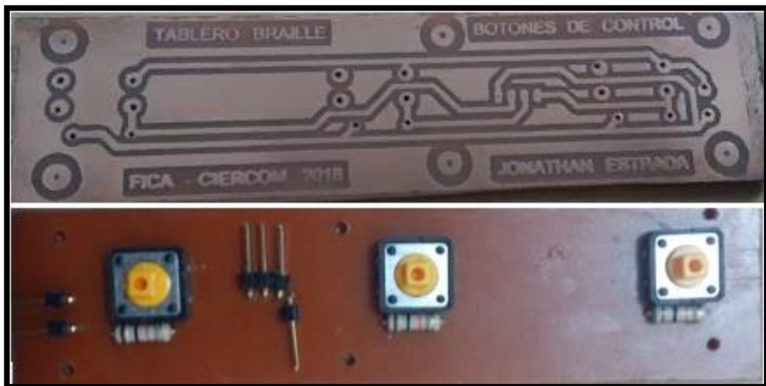
Figura 54: Placa bloque de Verificación
