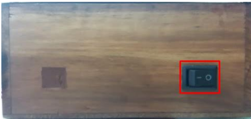
Figura 29: Botón encendido/Apagado del tablero
