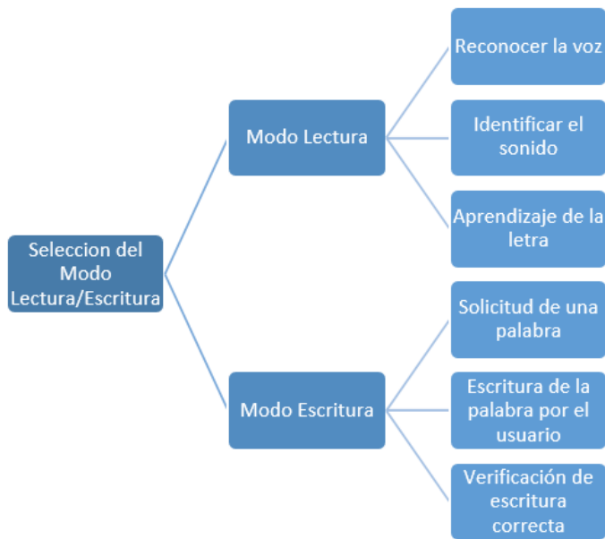
Figura 5: Funcionamiento general del tablero
