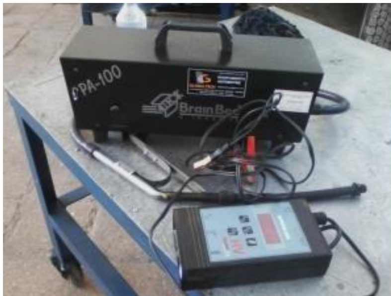
Figura 4.8 Conexión opacímetro y cuenta revoluciones
