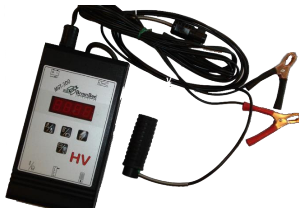
Figura II.3. Cuenta-revoluciones MGT-300 Brain Bee. (GLOBALTECH, 2016, p.1)
