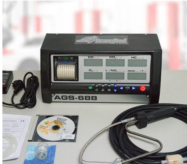
Figura 4.5 Conexión del analizador de gases AGS-688Brain Bee
