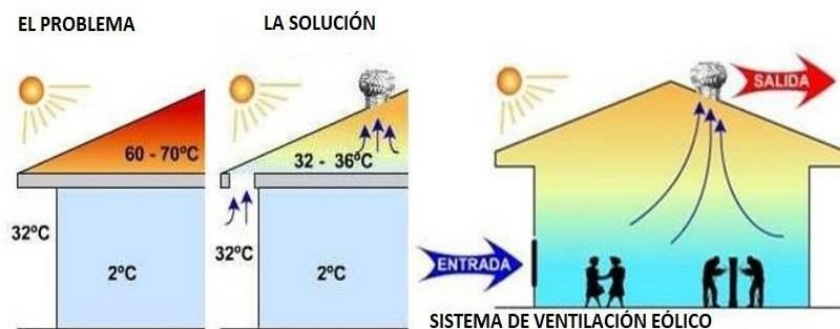
Figura 3.6 Función de un extractor eólico (SUMYTECK, 2011, pág.2)
