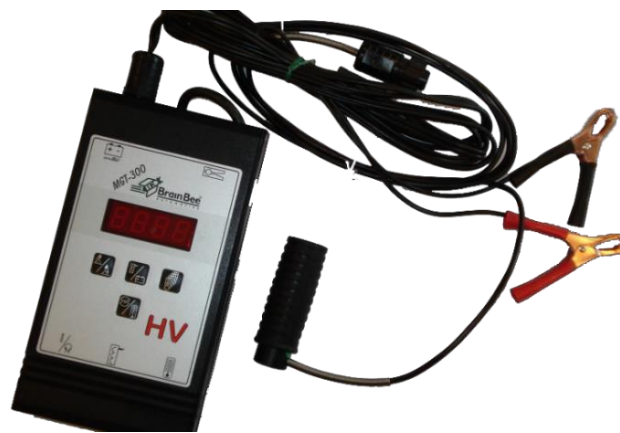
Figura 4.6 Dispositivo Cuenta-revoluciones MGT-300 Brain Bee
