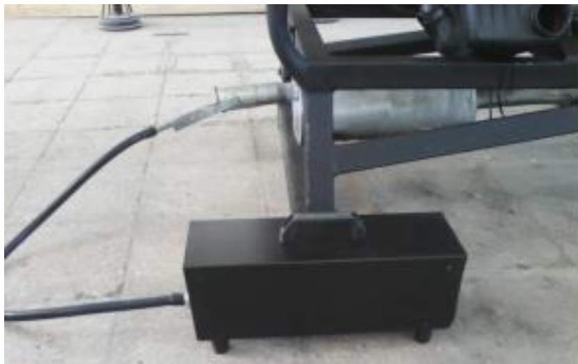
Figura 4.9 Medición de gases del motor con opacímetro
