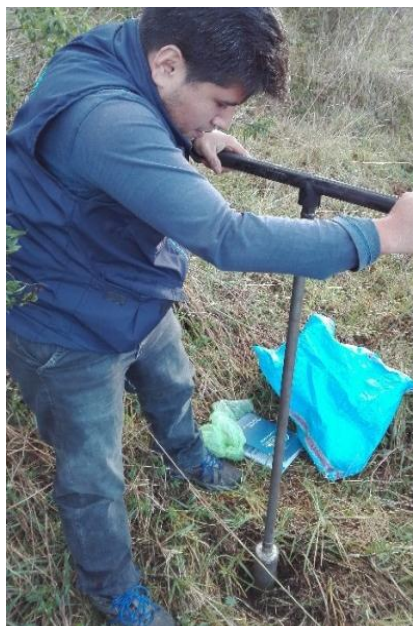
Figura 7. Toma de muestras de suelo implementando un barreno.
