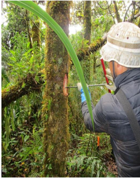
9. Extracción de una muestra de fuste con la ayuda del taladro de Pressler.
