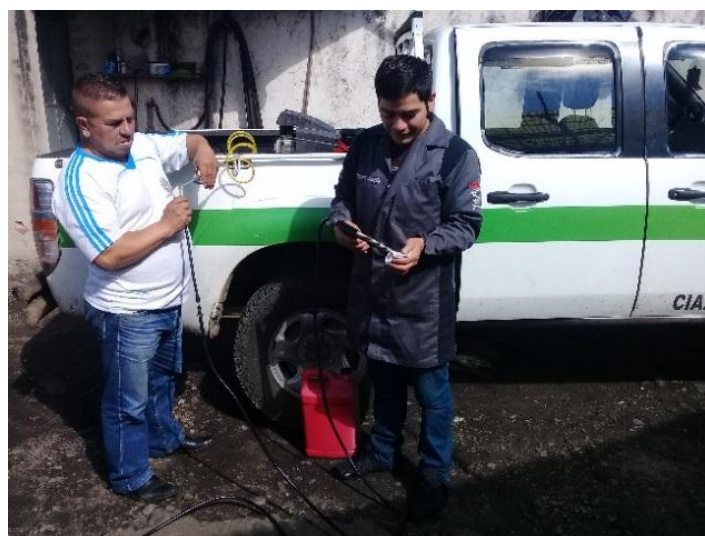
Figura 3. 8 Limpieza de la sonda con aire
