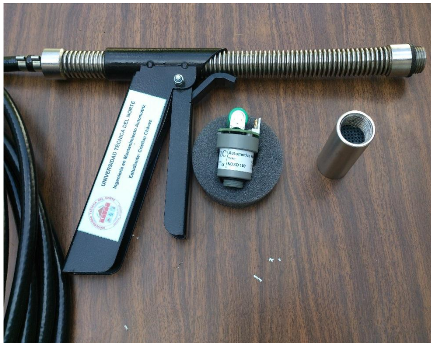
A I. 1 Sonda SGD-010, sensor NO x y filtro de partículas
