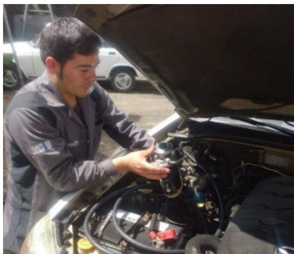
Figura 3. 15 Sustitución del filtro de combustible
