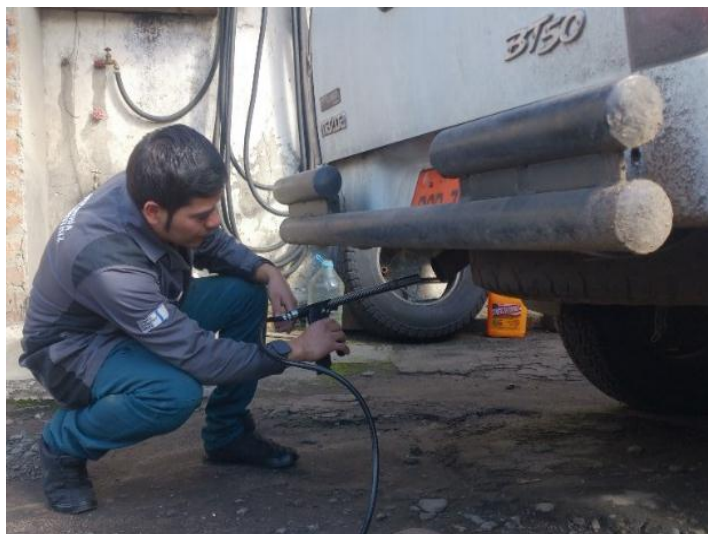
Figura 3. 7 Instalación de la sonda SGD-010 en el tubo de escape
