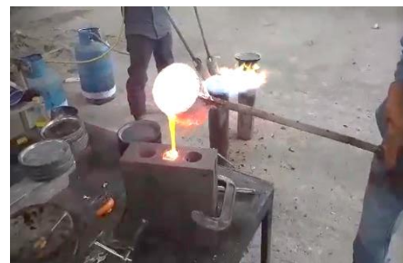
Figura 3.11. Vertido del metal fundido a 750°C
