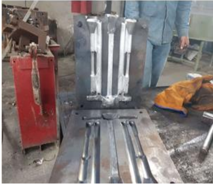
Figura 3.12. Extracción de la pieza
