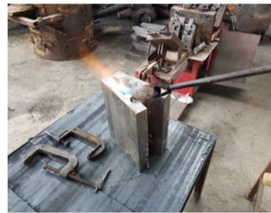
Figura 3.10. Precalentamiento de la matriz a 450°C
