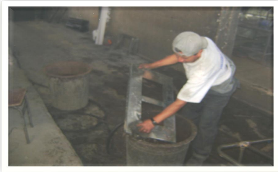
Proceso de desoxidación del tablero
