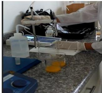
**Figura 11.** Determinación de pH (Potenciómetro)
