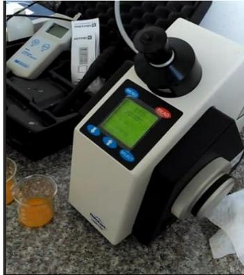
**Figura 9.** Refractómetro de mesa
