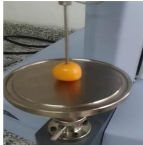
Figura 13. Texturómetro (modelo EZ-9X)
