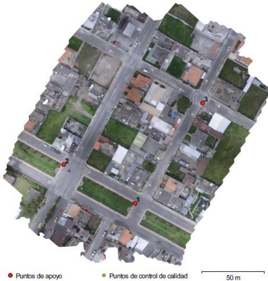
**Figura 13:** Puntos de control en ortofotografía.
