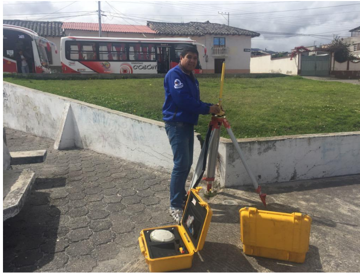
Fotografía #1. Armado de equipo GNSS-RTK
