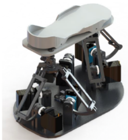
Figura 3: Robot paralelo tipo delta para rehabilitación de tobillo (Byron Zurita, 2018).
