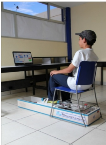
Figura 13: Dispositivo para la rehabilitación pasiva del tobillo (Valdivia, 2014).
