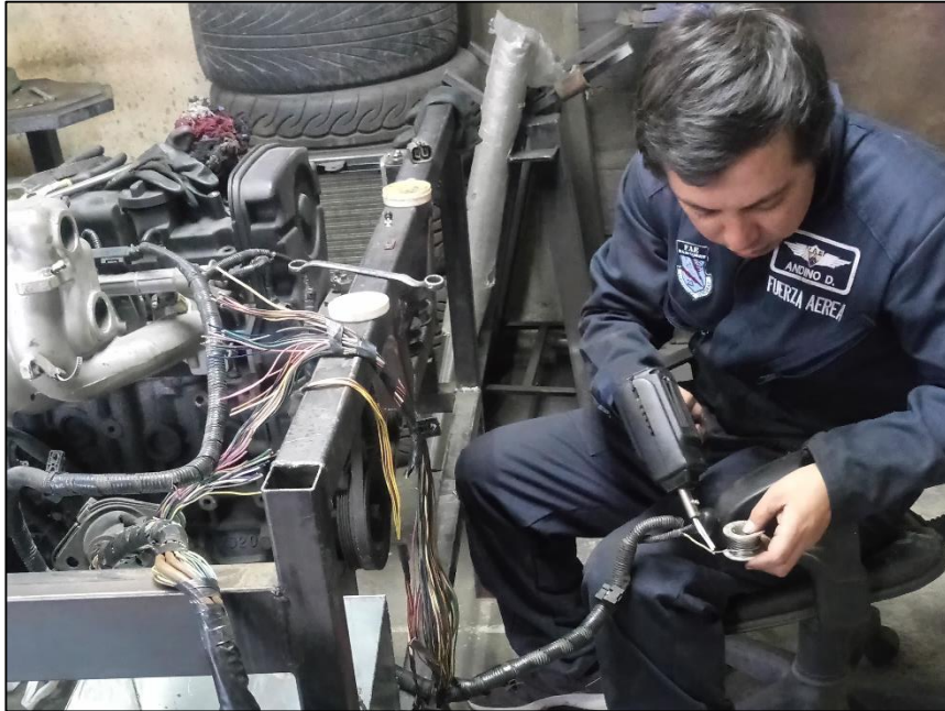
Figura AII.7 Extracción de todas las señales eléctricas al tablero de instrumentación
