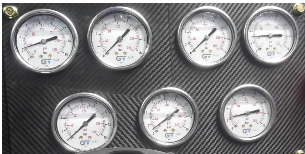
Figura 3.13 Manómetros en la posición N de la transmisión
