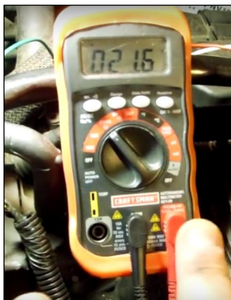
Figura 3.4 Medición de resistencias a elementos internos de la caja
