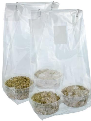
Figura 8. Bioceldas en bolsas con aireación.
