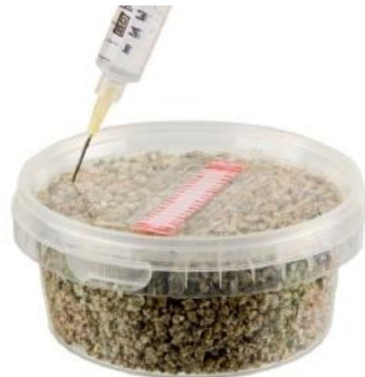
Figura 7. Jeringa flameada (a) e inoculación de bioceldas (b) (Innervisions, s. f.).
