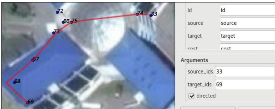
Figura 60. Ruta generada con el algoritmo de Dijkstra del punto 33 (Biblioteca) al punto 69 (CAI). Fuente: Autoría
