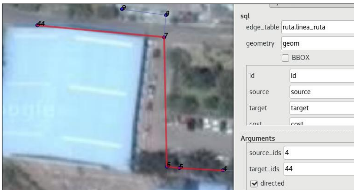
Figura 42. Ruta generada con el algoritmo de Dijkstra del punto 44 (cancha Sintética 1) al punto 4 (Comedor Universitario)
