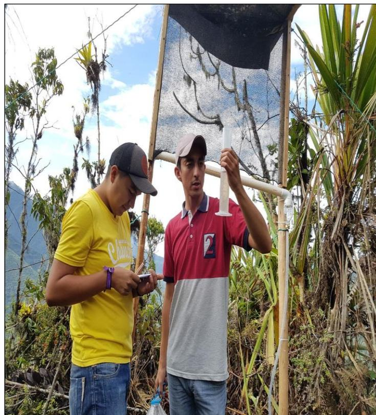
**Anexo 1o.** Medición de la precipitación horizontal en la estación 4.
