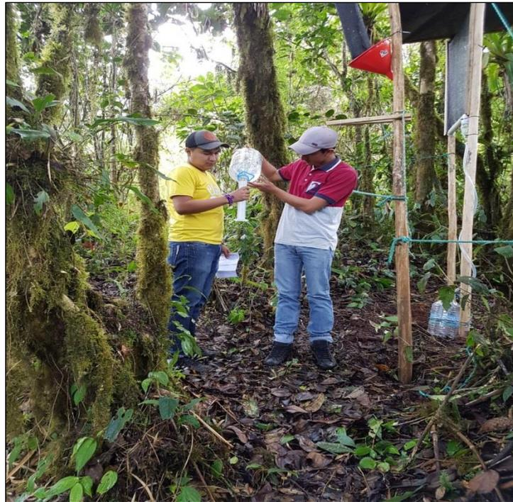
**Anexo 1n.** Medición de la precipitación horizontal en la estación 3.
