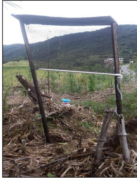
**Anexo 1l.** Medición de la precipitación horizontal en la estación 1.
