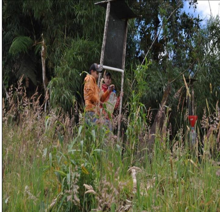
**Anexo 1p.** Medición de la precipitación vertical en el pluviómetro manual en la estación 3.
