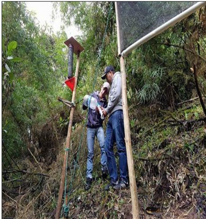
**Anexo 1m.** Medición de la precipitación horizontal en la estación 2.
