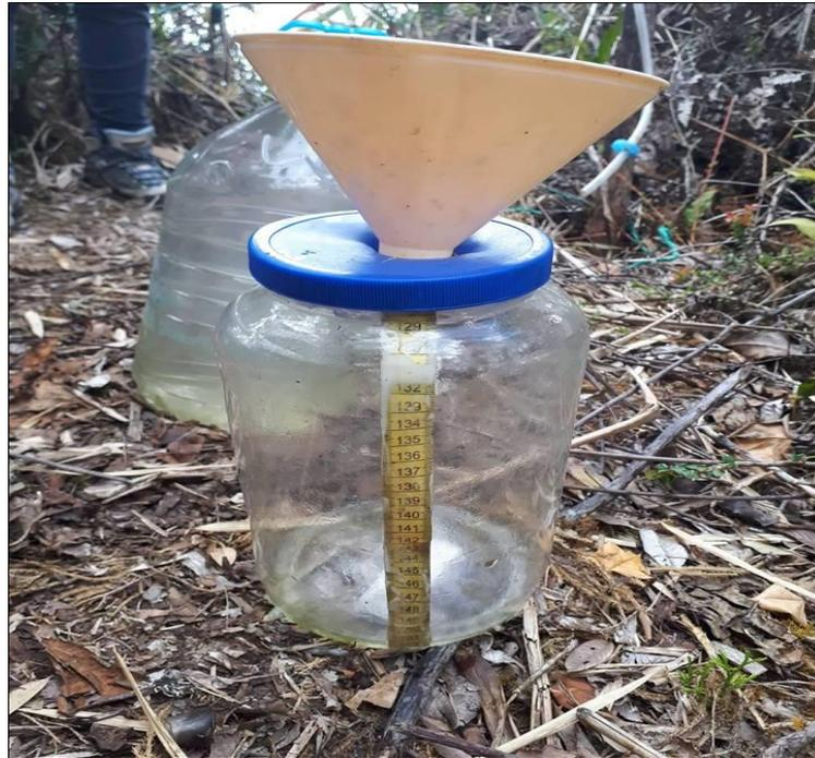
**Figura 11.** Pluviómetro casero de medición manual
