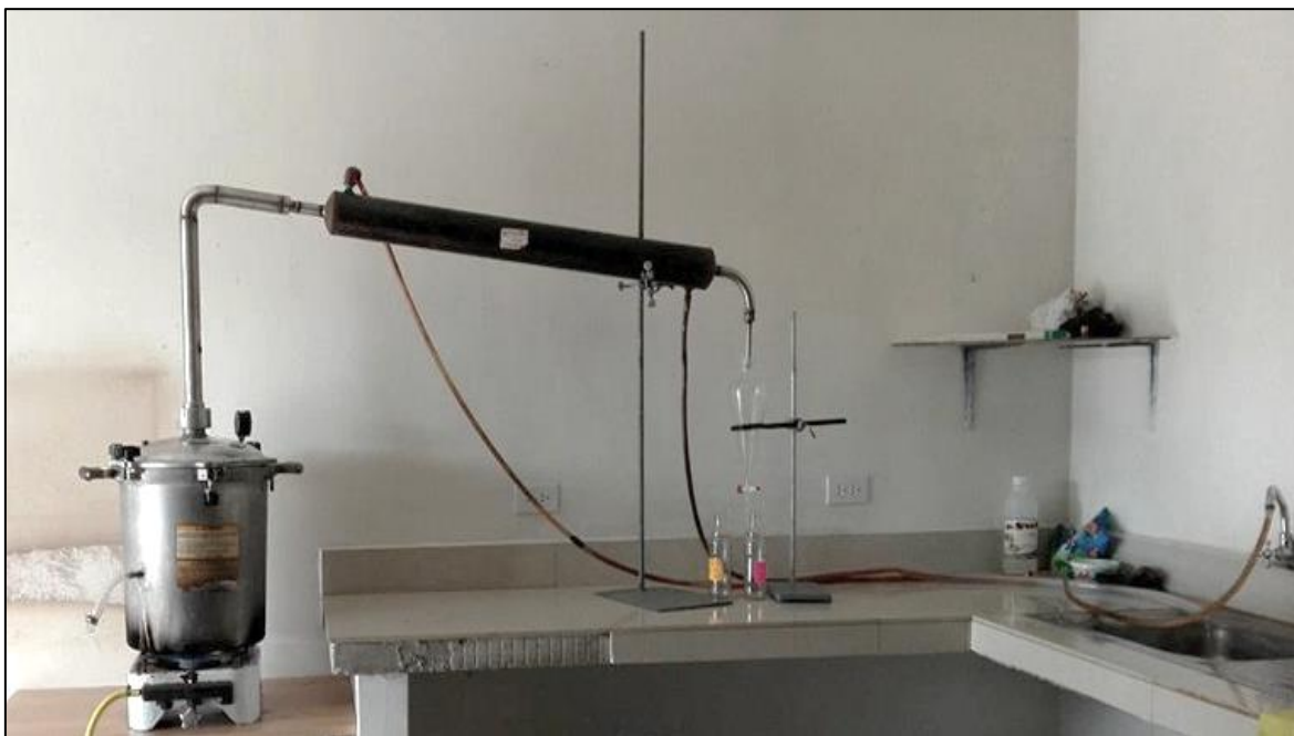
Figura 2. Equipo de destilación por arrastre de vapor de la Universidad Técnica del Norte.
